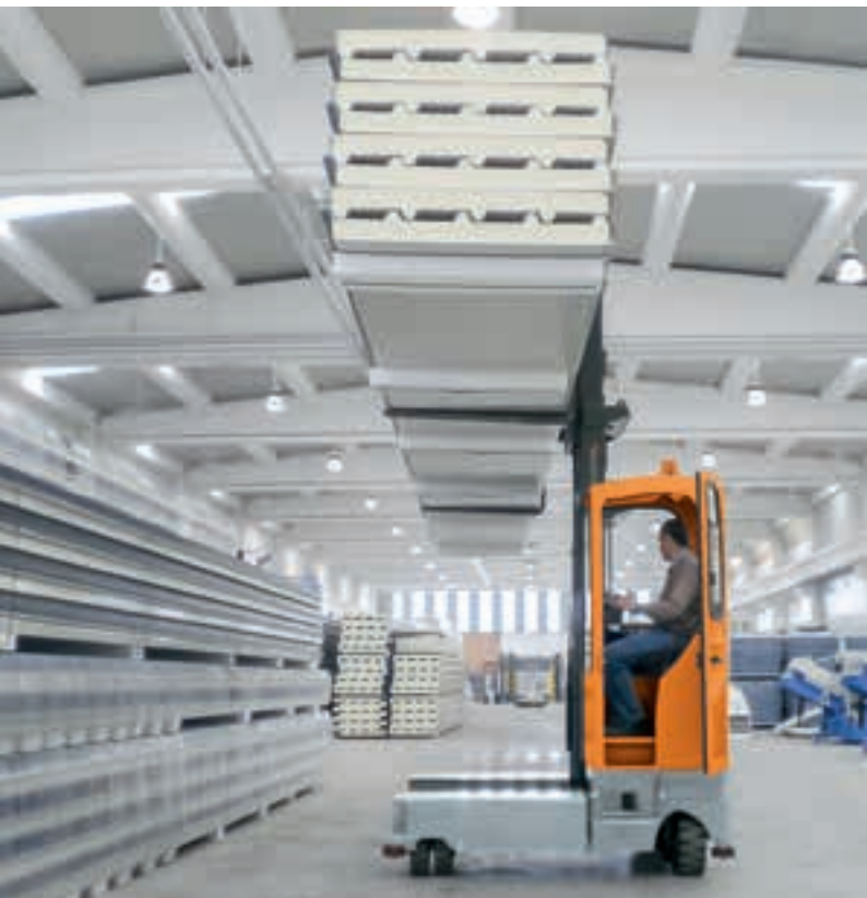
Elektrische meerwegzijlader met rubber banden voor binnen- en buiteninzet Weichbereifter Elektro-Mehrwege-Seitenstapler
