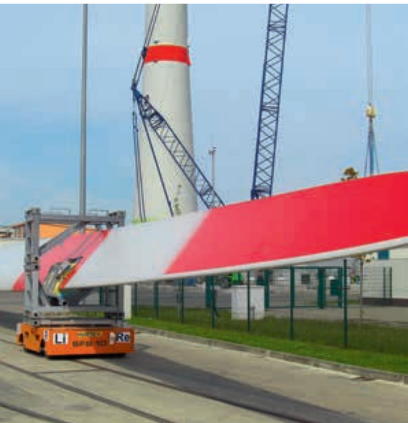
Platformwagen voor het transport van rotorbladen van windmolens Platformwagen für den Transport von Rotorblättern für Windkraftanlagen
