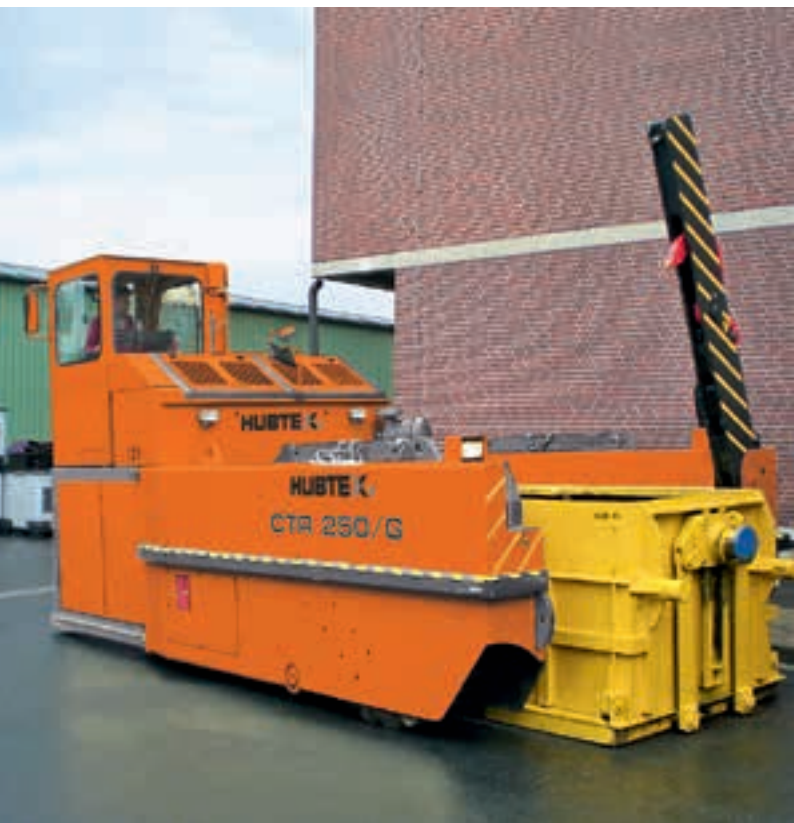
Transporter voor schrootcontainers, capaciteit tot 50 t Transporter für Schrott-Container, Tragfähigkeit bis 50 t
