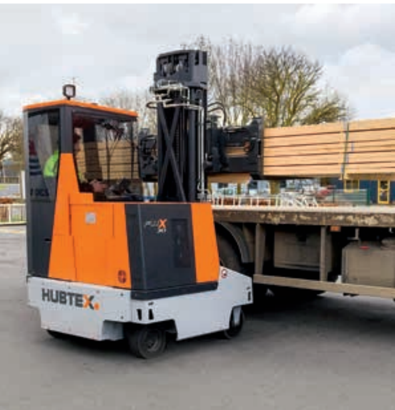
Meerweg heftruck om vrachtwagens te laden en te lossen Gegengewichts-Mehrwegestapler für das Be- und Entladen von LKW
