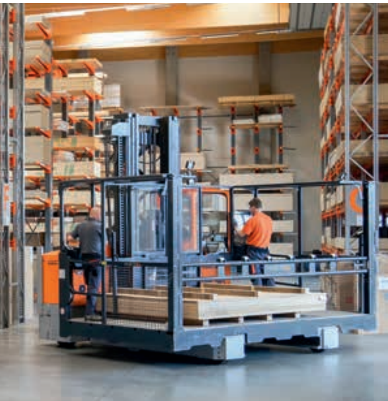
Meerwegzijlader met opneembaar orderverzamelplatform Mehrwege-Seitenstapler mit aufnehmbarer Kommissionierplattform
