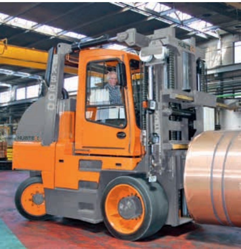
Compacte gasvorkheftruck, draagvermogen 20 t Gas-Kompaktstapler, Tragfähigkeit 20 t
