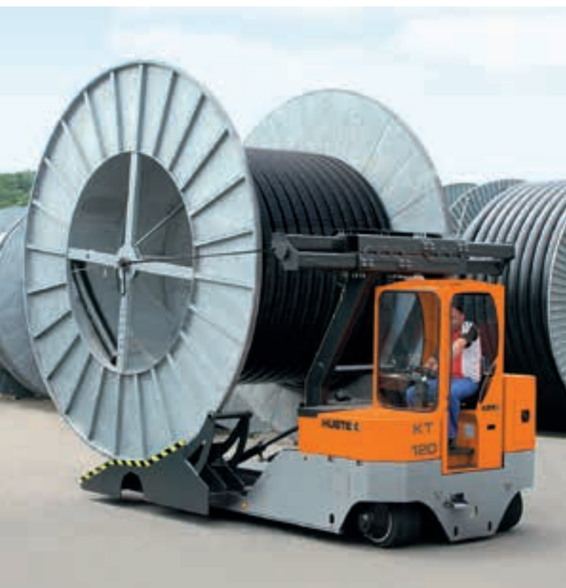
Haspeltruck met 12 t draagvermogen voor stadsverwarmingsbuizen Trommeltransporter mit 12 t Tragfähigkeit
