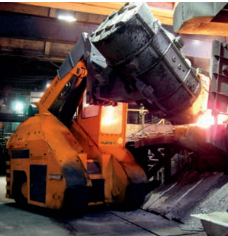
Compacte heftruck met telescooparm voor handling van gietpannen Teleskoparm-Kompaktstapler für das Handling von Konvertern
