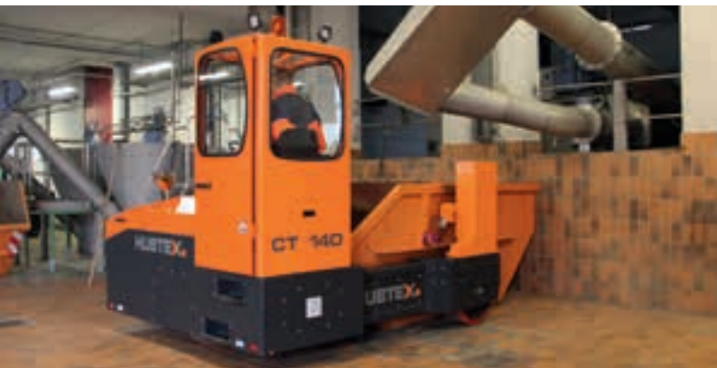
Containertransporter met hefframe of vorken Muldentransporter mit Gabelzinken oder Hebegeschirr
