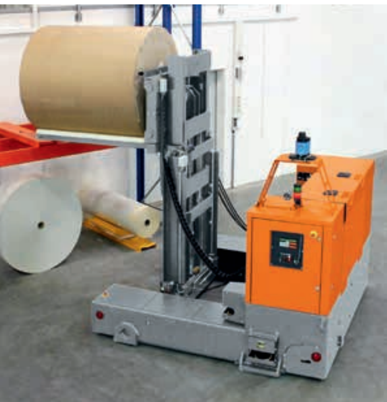
Automatisch bestuurd transportsysteem voor het manipuleren van rollen Fahrerloses Transportsystem zum Handling von Rollen
