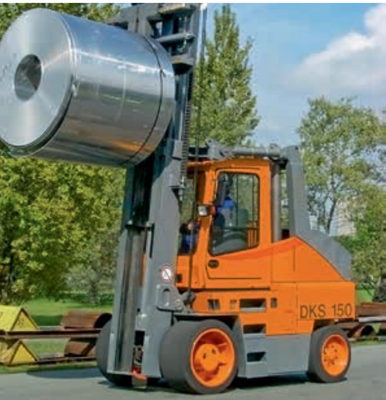
Compacte heftruck voor zware lasten, 12 – 15 t, naar keuze diesel- of gasaandrijving Schwerlast-Kompaktstapler, 12 – 15 t, wahlweise Diesel- oder Gasantrieb
