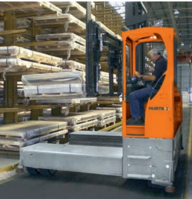
Meerweg-zijlader in aluminiumplaten magazijn Mehrwege-Seitenstapler im Alublech-Lager
