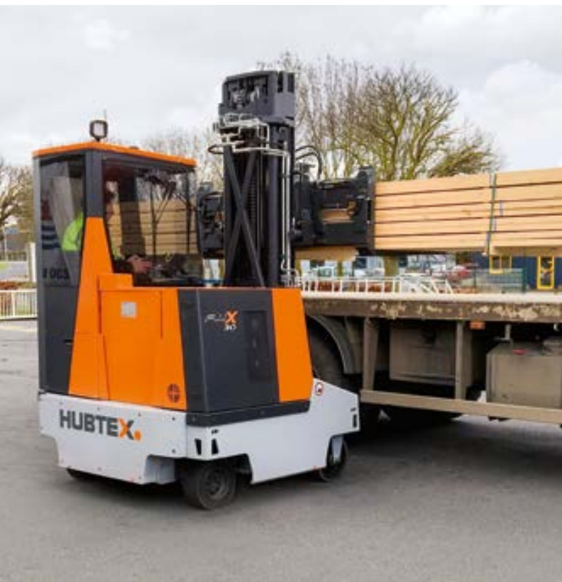
Gegengewichts-Mehrwegestapler für das Be- und Entladen von LKW Counterbalance Multidirectional Forklift for loading and unloading truck trailers
