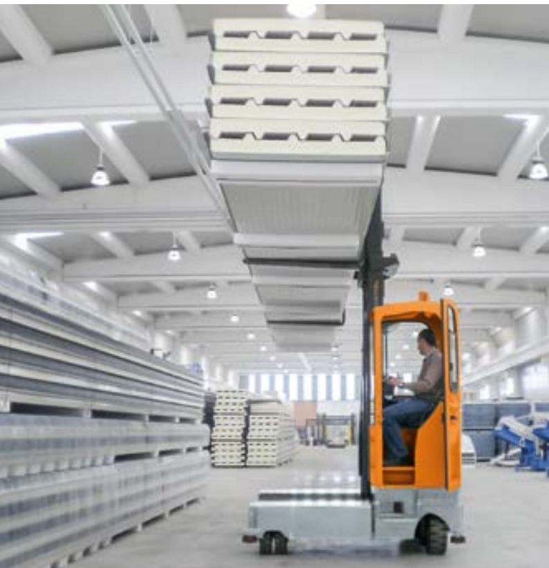
Weichbereifter Elektro-Mehrwege-Seitenstapler Electric-Multidirectional-Sideloader with soft tyres
