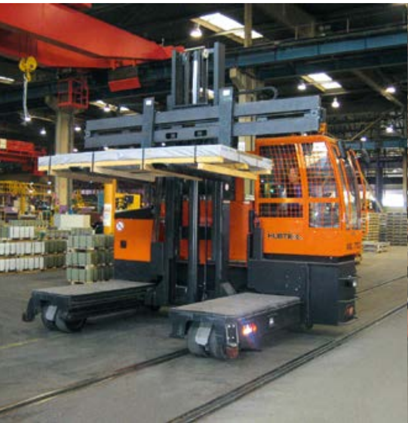
Elektro-Mehrwege-Seitenstapler mit Seitenstaplerkabine Electric-Multidirectional-Sideloader with sideloader cabin
