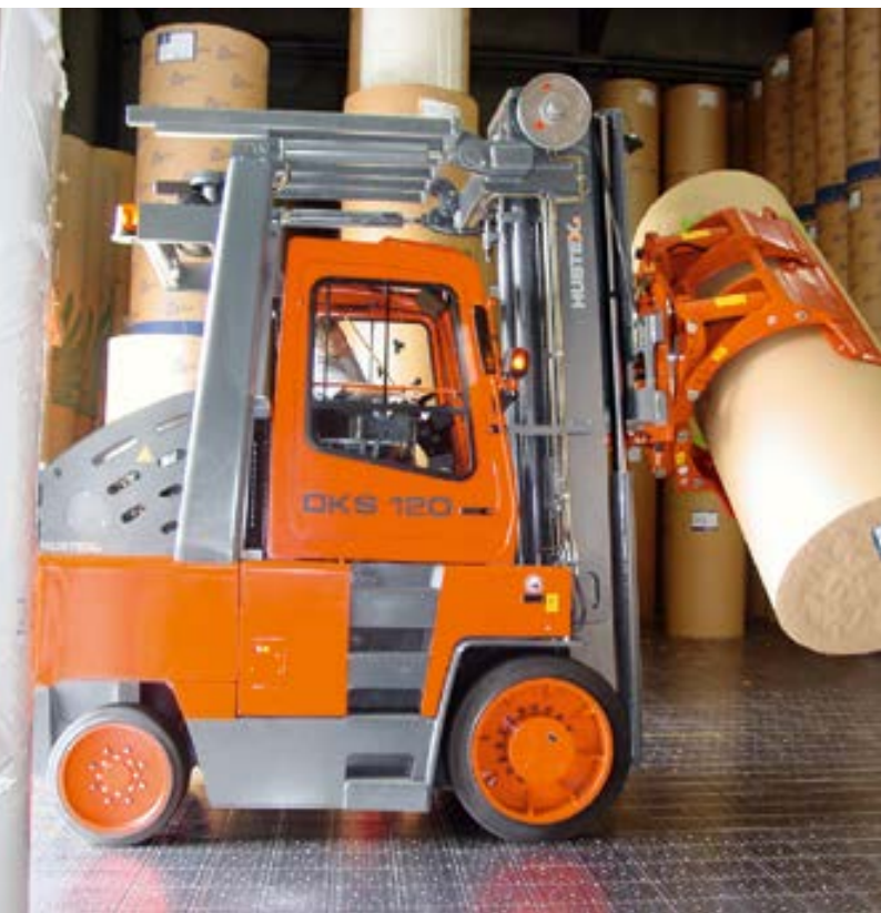
Kompaktstapler mit drehbarer Papierrollenklammer Compact frontlift with rotatable paper roll clamp
