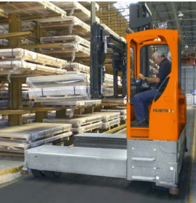
Mehrwege-Seitenstapler im Alublech-Lager Multidirectional Sideloader aluminium sheet warehouse
