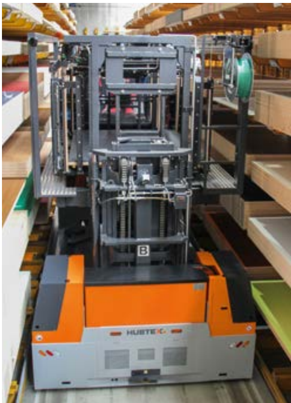
VacumaX beim Kommissionieren von Platten VacumaX for order-picking of plates
