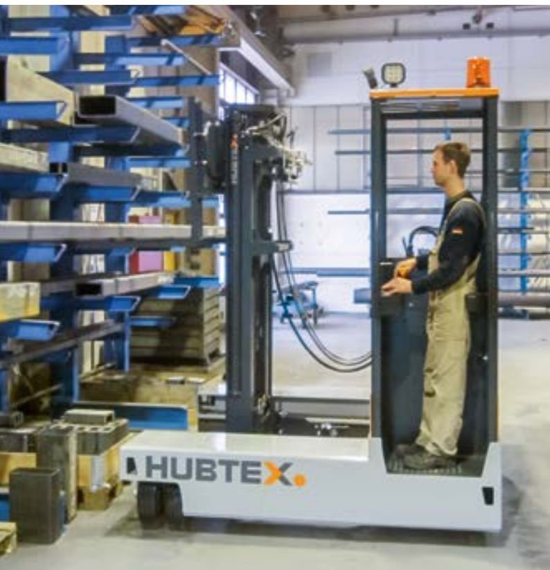
Elektro-Mehrwege-Seitenstapler in der Drei-Rad-Ausführung Electric-Multidirectional-Sideloader as three-wheel-model
