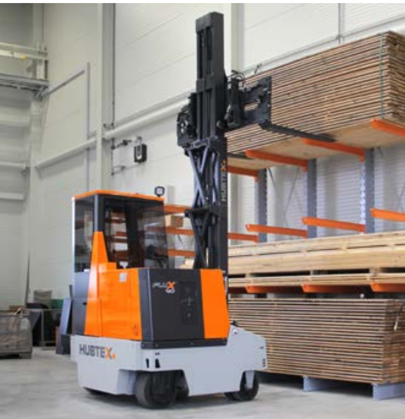
Mehrwege-Seitenstapler beim Handling von Schnittholz Multidirectional-Sidelaoder for handling of trimmed timber
