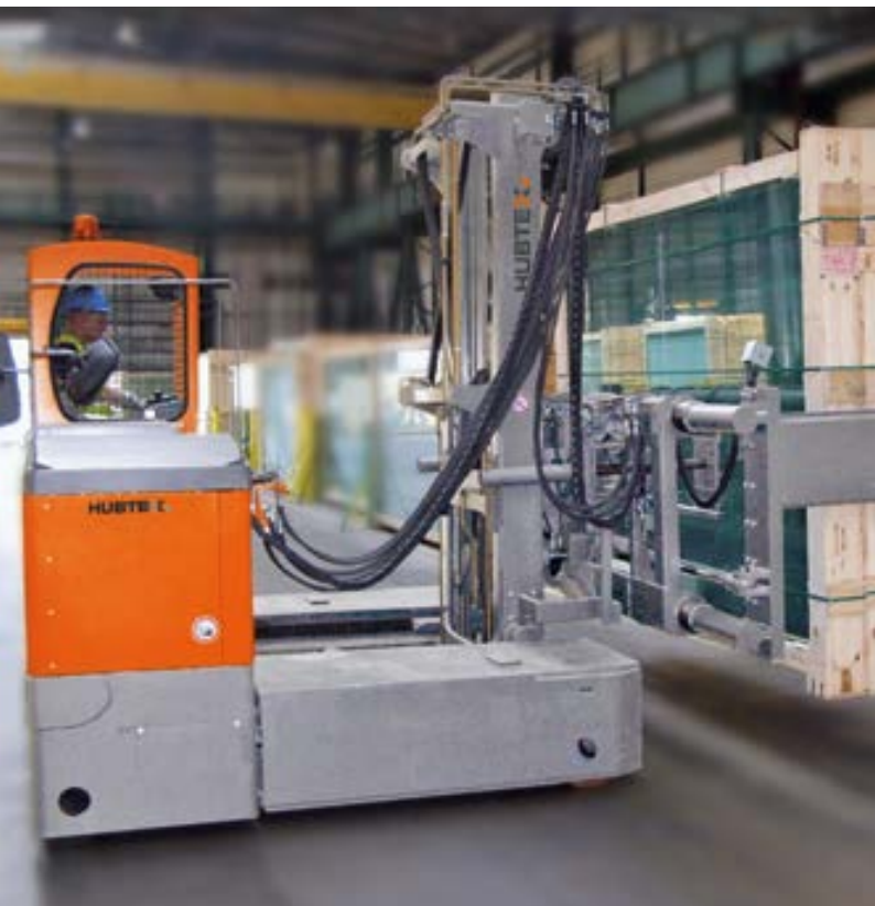
Mehrwege-Seitenstapler für die Aufnahme von verpackten Glaspaketen Multidirectional-Sideloader for handling of packed glass packs
