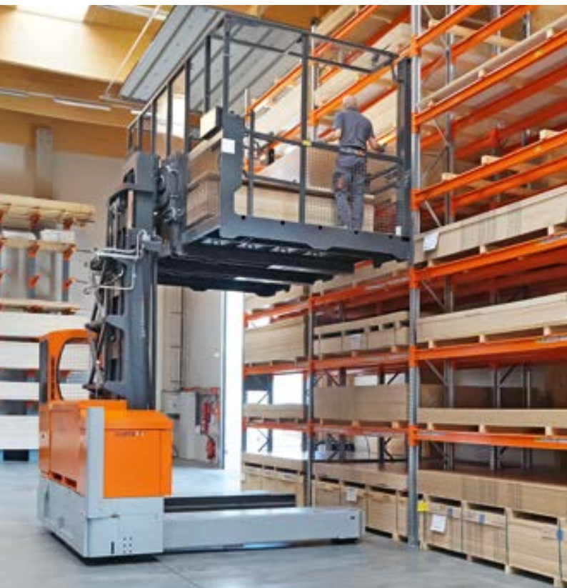
Elektro-Mehrwege-Seitenstapler beim Kommissionieren von Spanplatten Picking of boards with an Electric-Multidirectional-Sideloader
