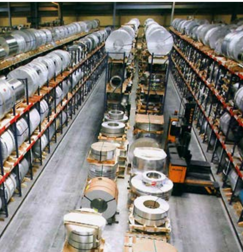
Mehrwege-Seitenstapler im Weißblech-Lager Multidirectional Sideloader in tinplate warehouse
