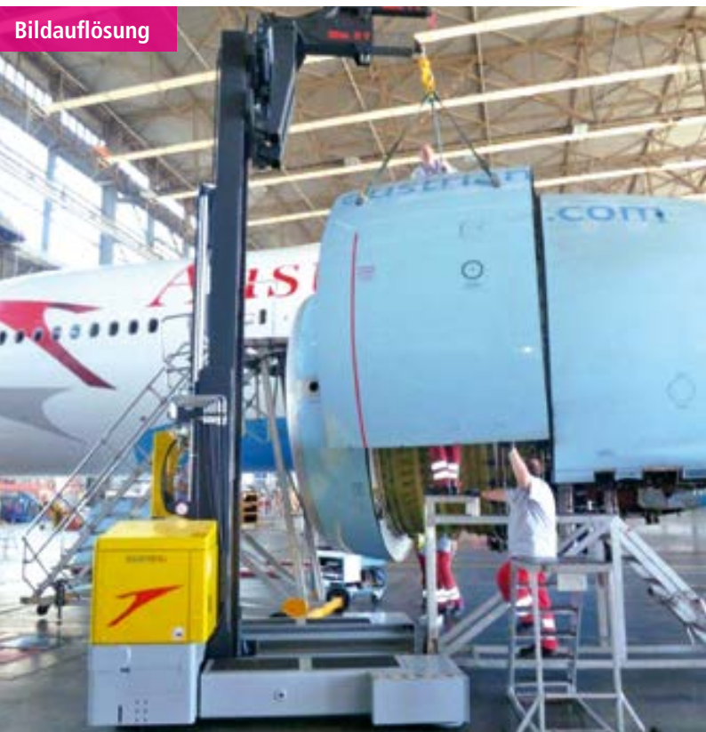
Mehrwege-Seitenstapler zum Einbau von Flugzeugkomponenten Mutidirectional-Sideloader for installation of aircraft components
