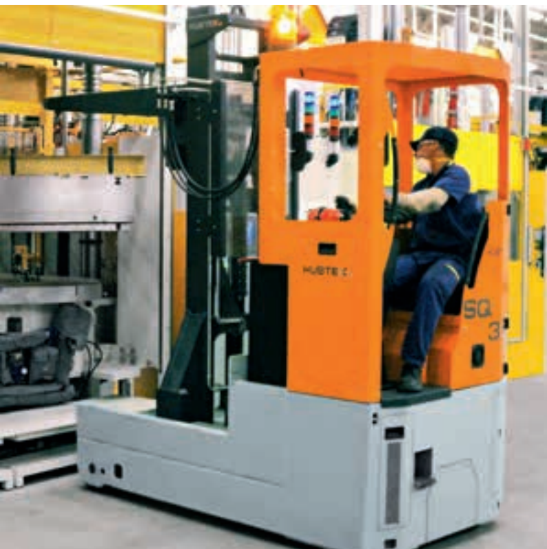
Chariot à mât rétractable pour la manutention de moules de pneus Carrello elevatore retrattile per la movimentazione di stampi per pneumatici
