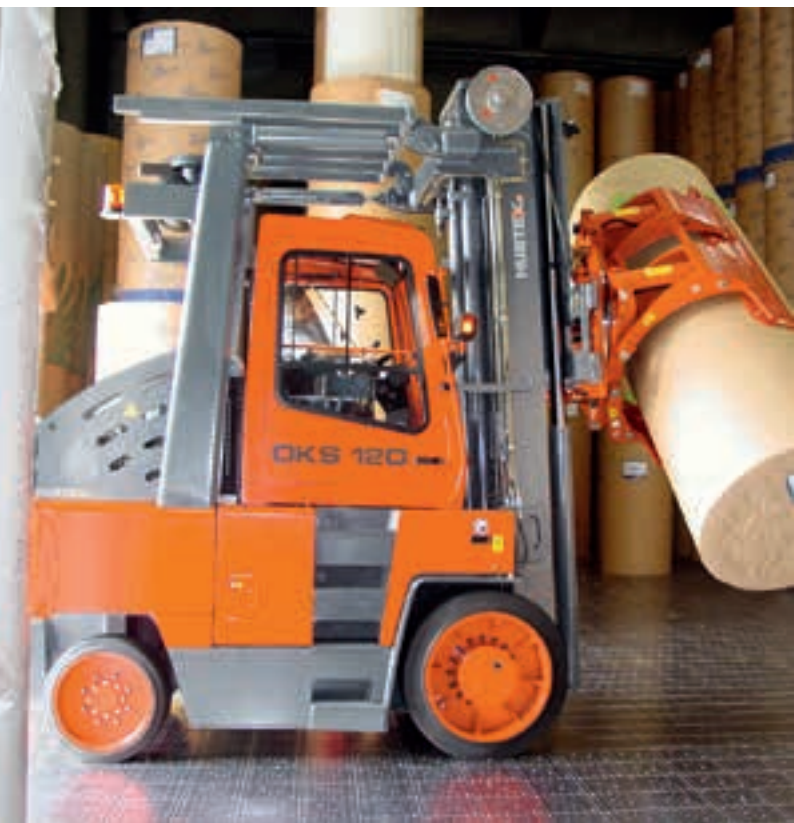
Chariot compact avec pince rotative pour rouleaux de papier Carrello elevatore compatto con pinza rotante per bobine di carta
