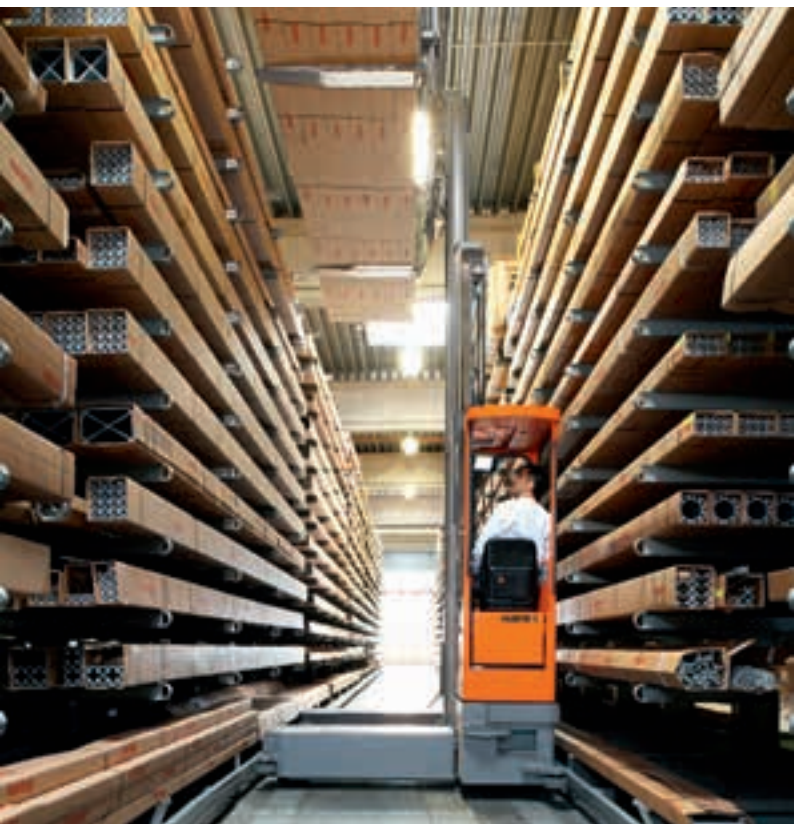
Chariot latéral électrique multidirectionnel en allée étroite Carrello elevatore laterale multidirezionale elettrico in corridoio stretto guidato
