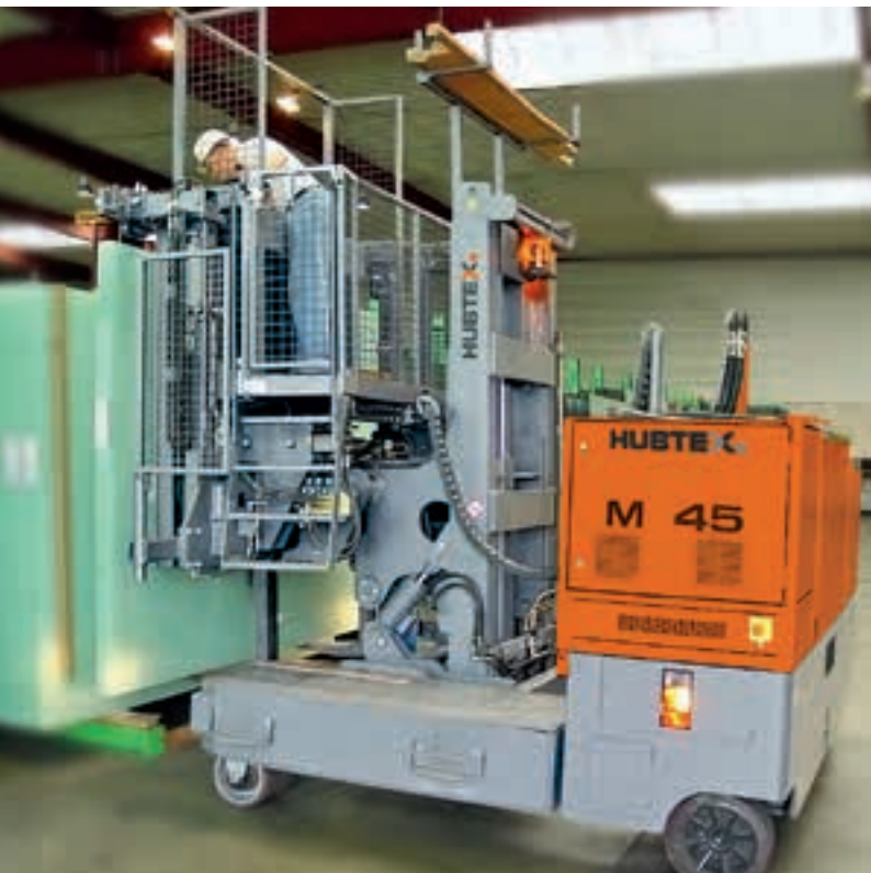
Chariot latéral multidirectionnel pour la manipulation de paquets de verre non emballés
