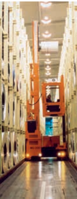
Chariot latéral multidirectionnel pour transport et stockage de charges lourdes Carrello elevatore laterale multidirezionale per carichi pesanti
