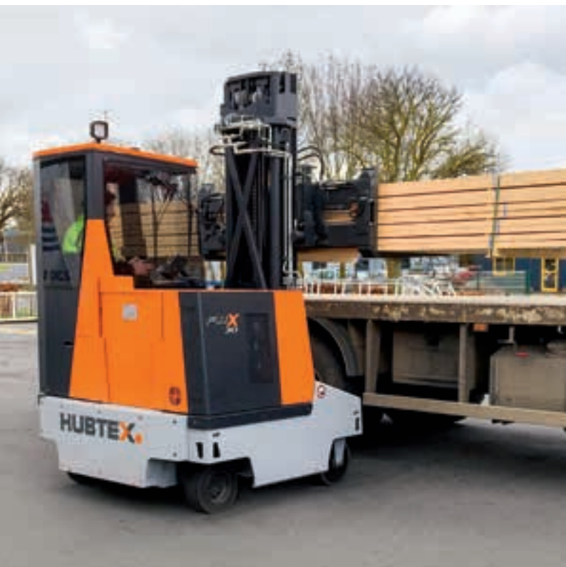
Chariot frontal multidirectionnel à contrepoids pour le chargement et le déchargement Carrello elevatore multidirezionale controbilanciato per il carico e lo scarico di camion
