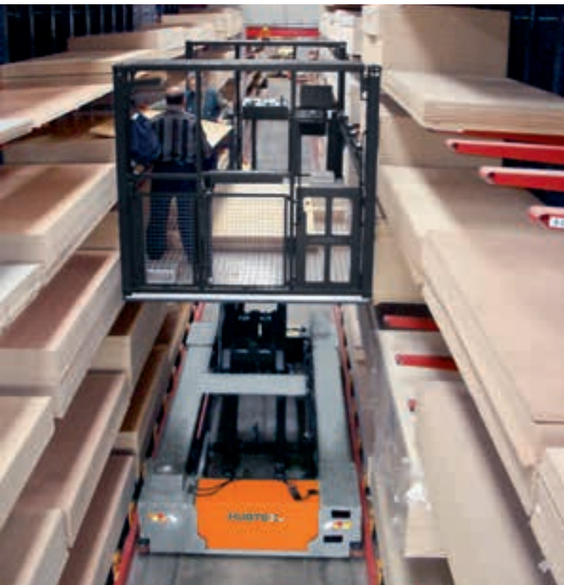
Chariot de préparation de commandes, capacités 2 - 12 t Piattaforma per picking degli ordini su due lati, portata 2 - 12 t
