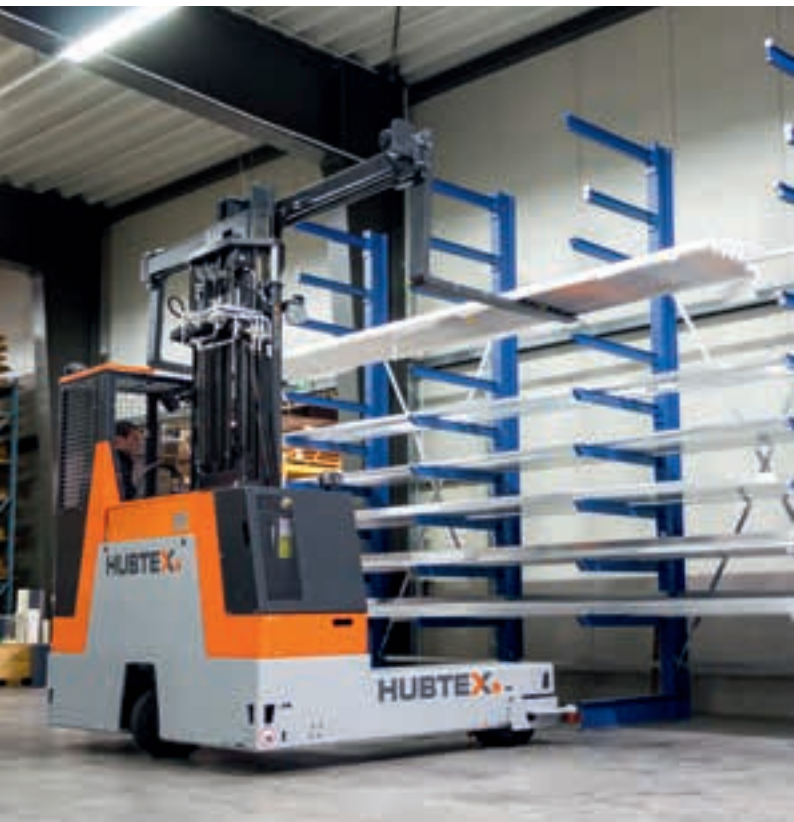
Chariot latéral multidirectionnel à faible hauteur d'accès cabine Carrello laterale multidirezionale con soglia di accesso vicina al suolo
