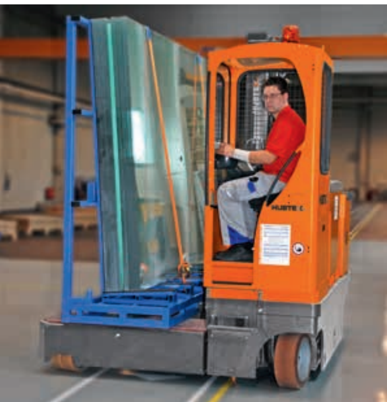
Transport de verre brut dans l'industrie solaire Trasporto di vetro grezzo nell'industria solare
