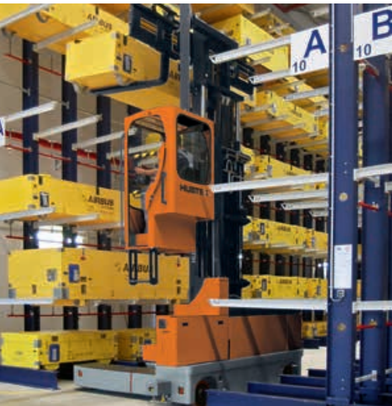
Chariot latéral multidirectionnel en entrepôt de pièces détachées d'avion Carrello elevatore laterale multidirezionale in magazzino del settore aviazione
