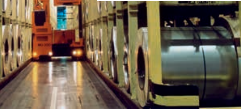
Chariot latéral multidirectionnel pour transport et stockage de charges lourdes Carrello elevatore laterale multidirezionale per carichi pesanti
