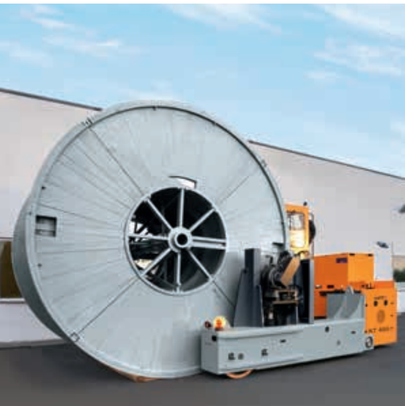
Transporteur de bobines de câbles d'une capacité de charge de 45 t Trasportatore di bobine di cavo, portata 45 t
