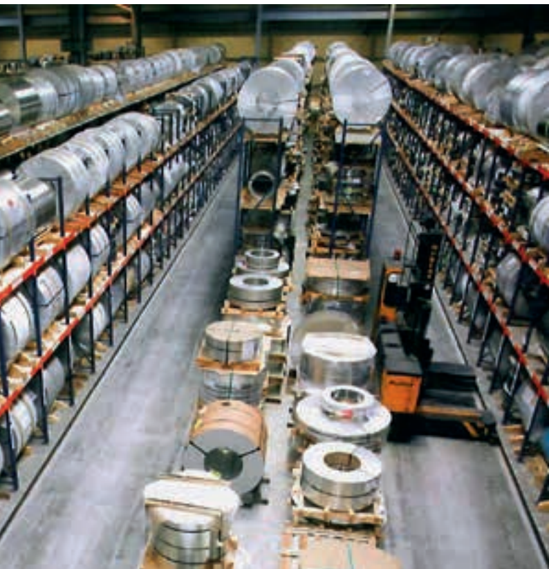
Chariot latéral multidirectionnel dans entrepôt de stockage de bobines Carrello elevatore laterale multidirezionale in magazzino di coils
