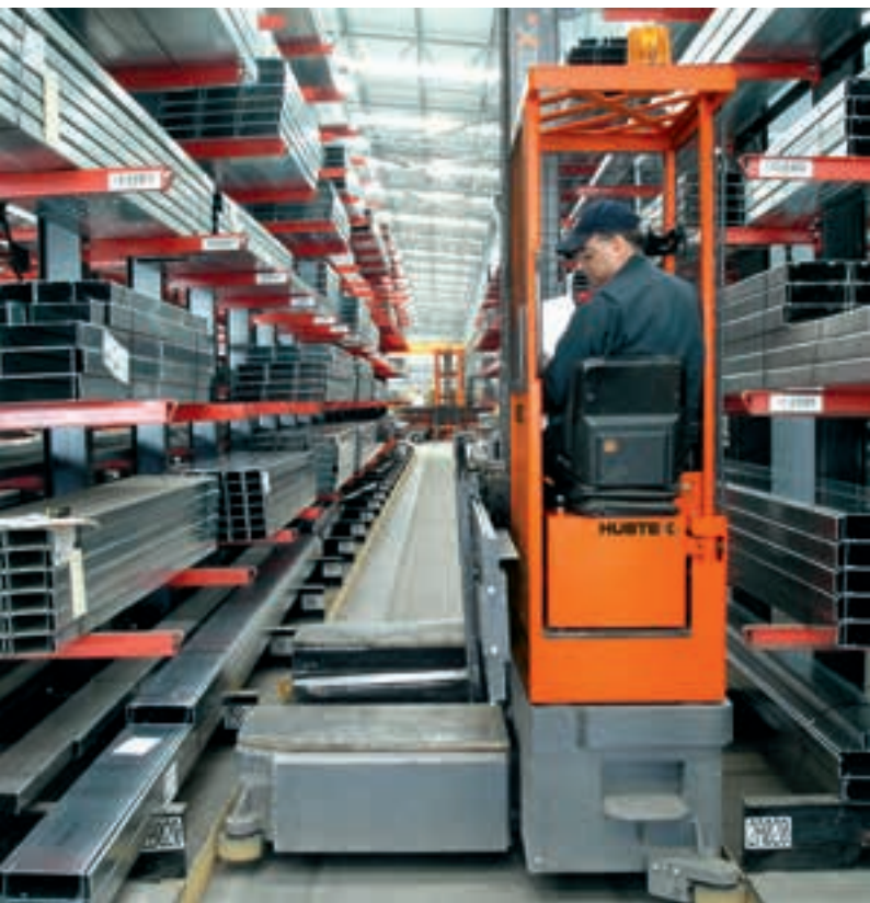
Chariot latéral multidirectionnel avec cabine à siège longitudinal Carrello elevatore laterale multidirezionale con cabina laterale
