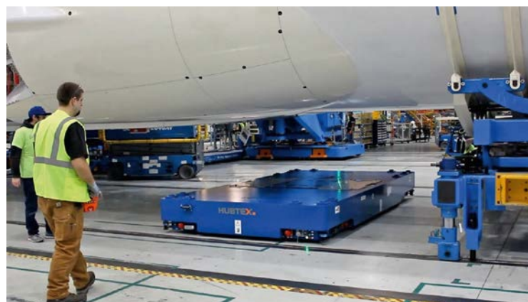
Le chariot plate-forme SL-AGV transporte un fuselage d'avion
