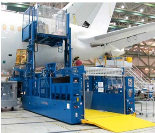
Une plate-forme de montage et de travail avec système de levage à 4 mâts
