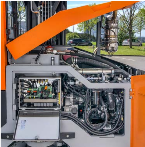
Moteur turbo à faible émission sonore conformément à la norme actuelle sur les émissions de gaz d'échappement
