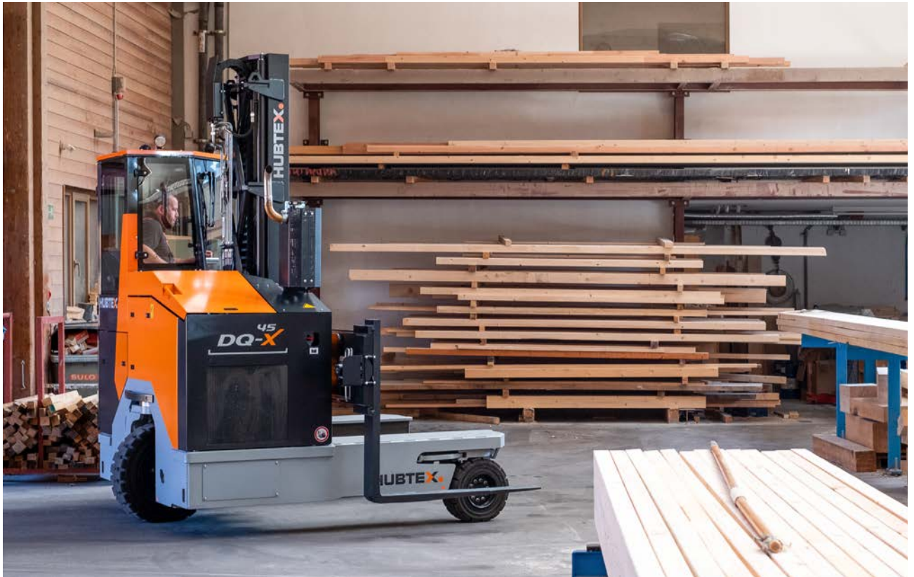
L'assistant de stabilisation innovant empêche les mouvements de balancement indésirables lors de freinages secs.
