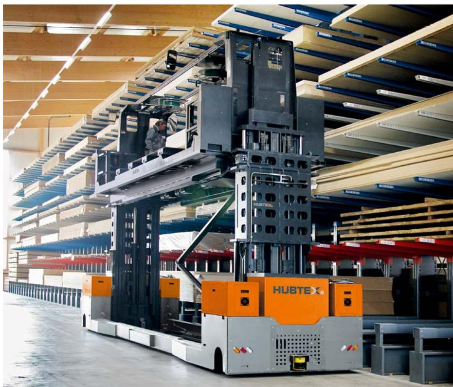
In der Praxis deutlich verbreiteter ist die Kombination der Plattformlösung mit einem Mehrwege-Seitenstapler zum Handling voller Pakete, beispielsweise zur Be- und Entladung von LKW oder der Einlagerung in die Regalanlage. Dabei fahren Mehrwegestapler und Kommissionierplattform im gleichen Gang. Diese praktische Kombination ist energieeffizienter und schafft eine höhere Flexibilität.
