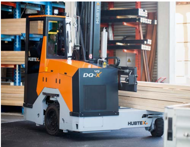
Lors d'un changement de direction, le frein de stationnement est automatiquement activé.
