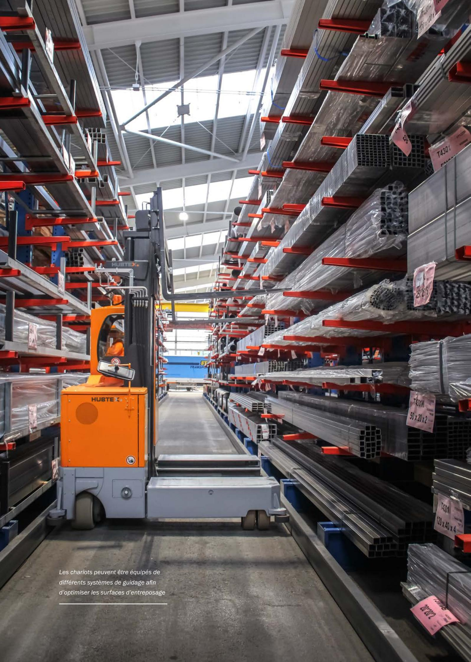
Les chariots peuvent être équipés de différents systèmes de guidage afin d'optimiser les surfaces d'entreposage
