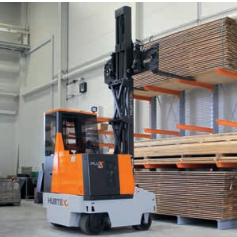
Empilhadeira contrabalançada multidirecional para a movimentação de aglomerados Carretilla elevadora con cargador lateral multidireccional para el manejo de tableros de aglomerado
