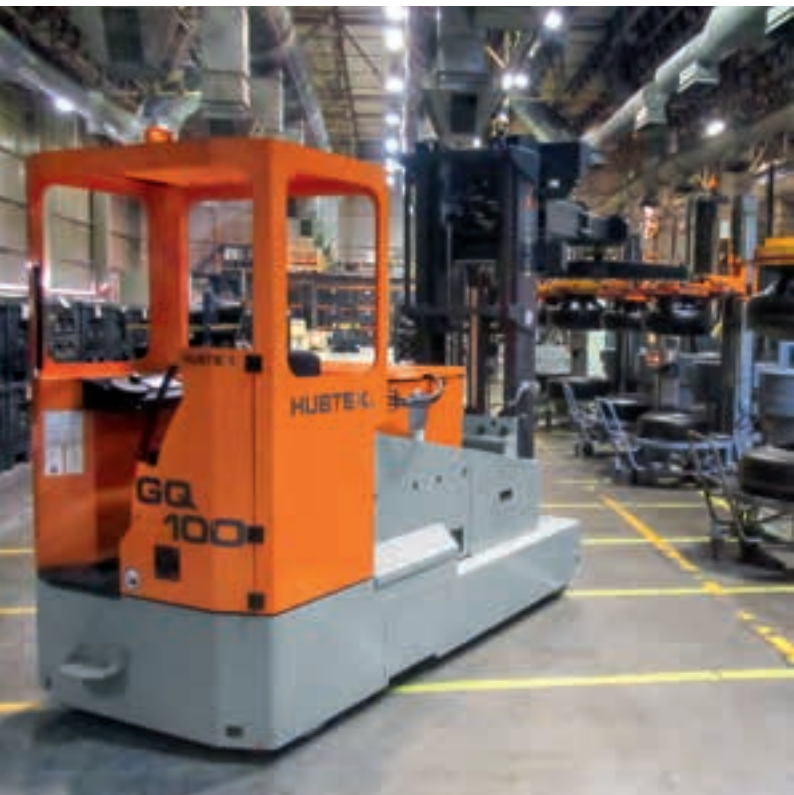
Empilhadeira de mastro retrátil para troca de moldes na indústria de pneumáticos Carretilla con mástil de elevación cambiando troqueles en la industria de los neumáticos
