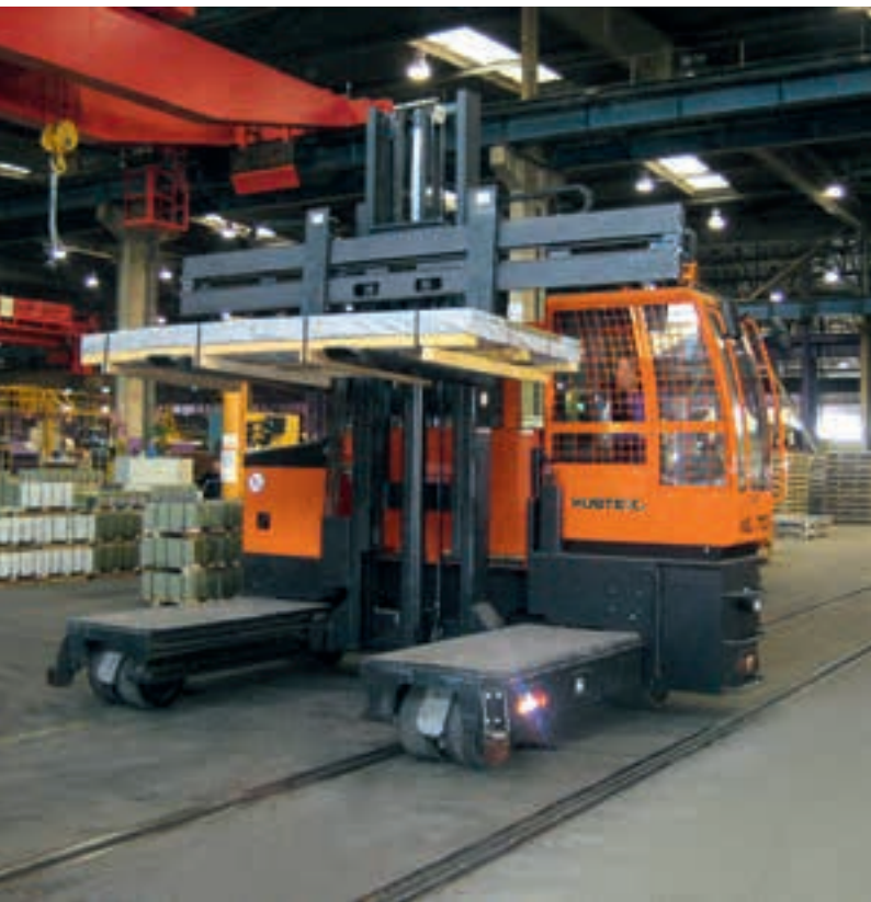
Empilhadeira lateral eléctrica multidireccional com cabina de empilhadeira lateral Carretilla elevadora eléctrica multidireccional con cabina lateral
