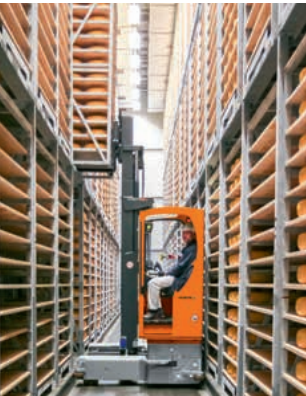
Empilhadeira lateral multidirecional na armazenagem de queijo Carretilla elevadora con cargador lateral multidireccional para el transporte de piezas de queso
