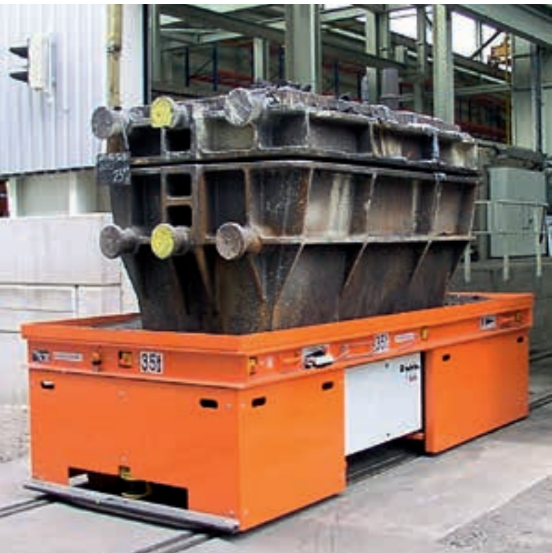
Carro elétrico sobre trilhos para o transporte de moldes Plataforma transportadora de moldes mediante raíles
