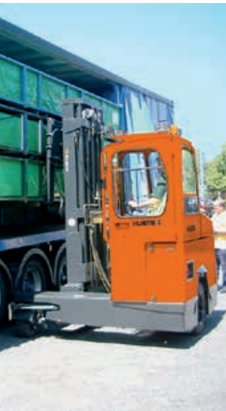
Empilhadeira lateral, quadridirecional, com acionamento a GLP ou Diesel Carretilla 4-caminos diésel o gas LPG
