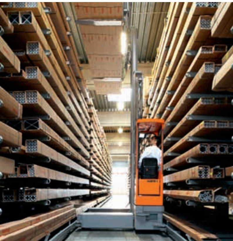
Empilhadeira elétrica lateral, multidirecional, em corredores estreitos Carretilla multidireccional eléctrica en pasillo guiado
