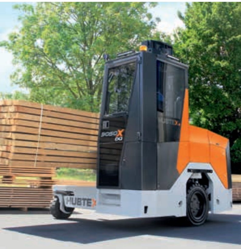
Empilhadeira lateral quadridirecional a Diesel para uso em interiores e exteriores Carretilla elevadora de cuatro direcciones diésel para uso interior y exterior
