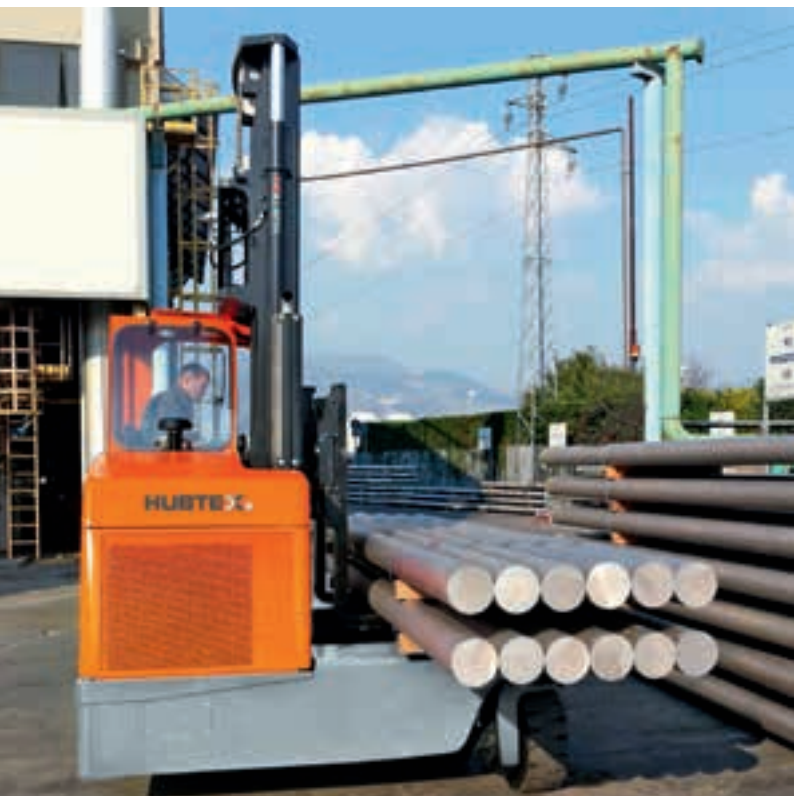
Empilhadeira lateral, multidirecional, com rodagem de borracha Carretilla multidireccional con ruedas superelásticas
