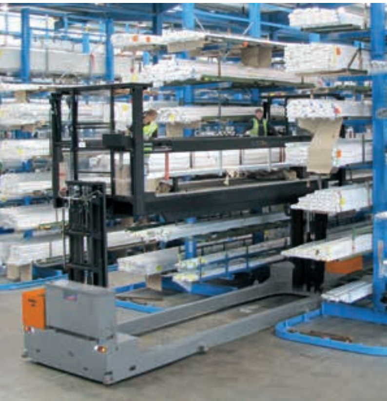
Selecionadora bilateral para operar em corredores estreitos Plataforma para picking de perfilería a ambos lados del pasillo en espacios mínimos
