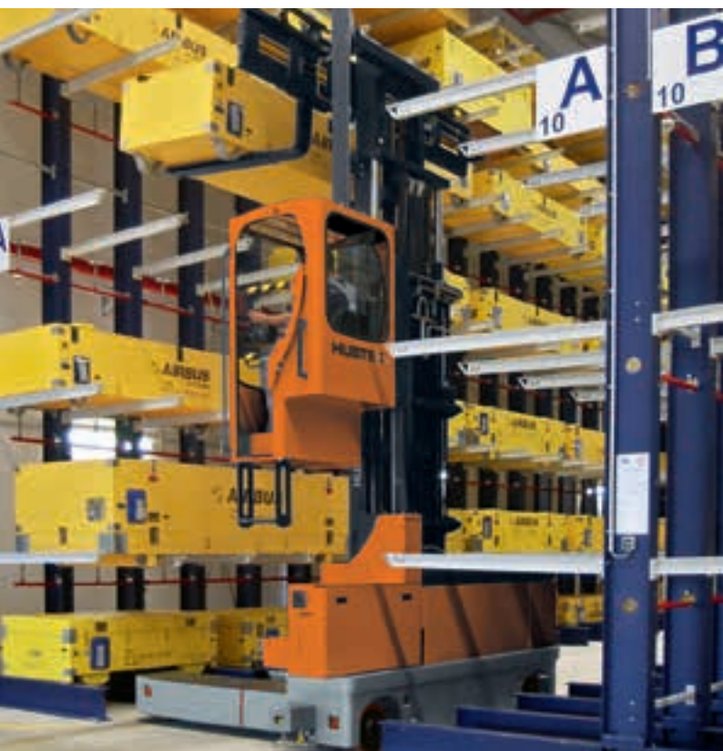
Empilhadeira elétrica lateral, multidirecional em armazém de peças para aeronaves Carretilla multidireccional eléctrica guiada en almacén de recambios aeronáuticos
