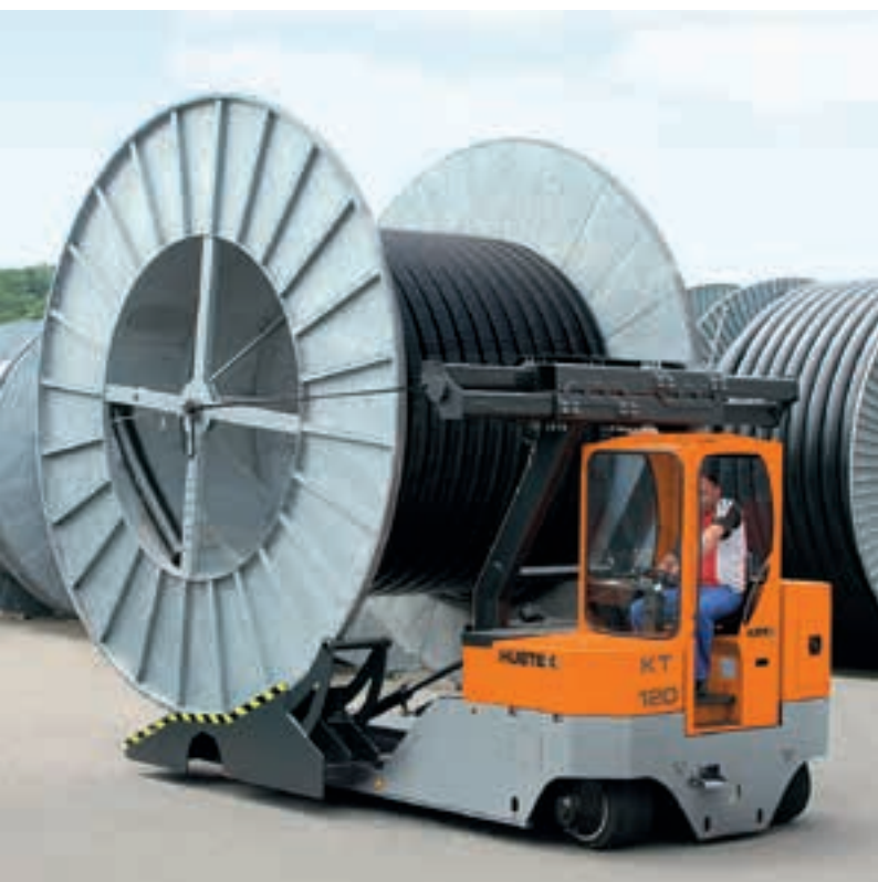
Transportador de carretéis com capacidade de até 12 t Transporte de bobina con capacidad de hasta 12 t para tubos de calefacción urbana
