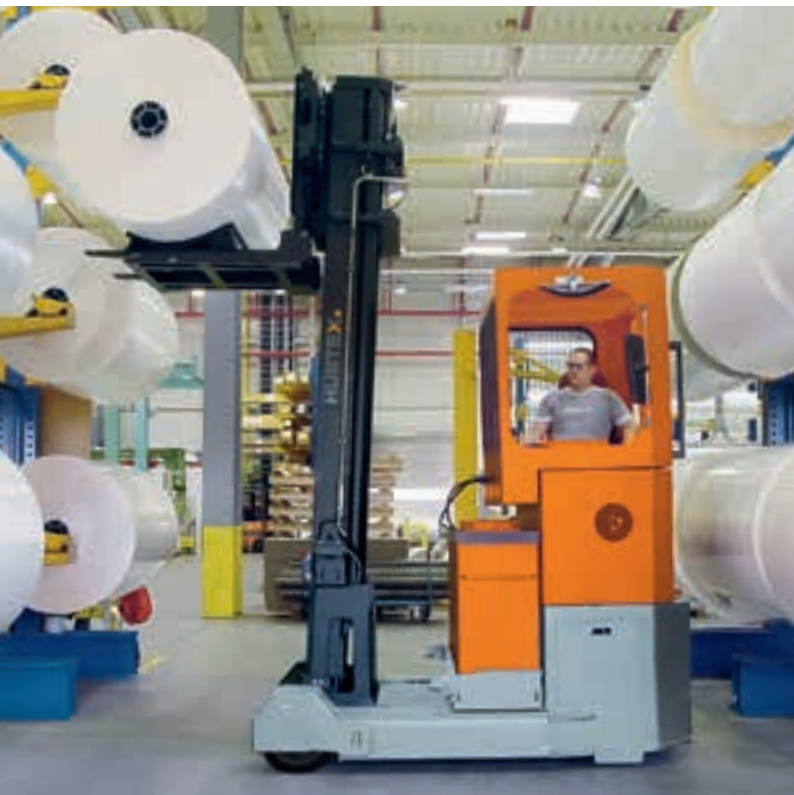
Empilhadeira de mastro retrátil na movimentação de bobinas de papel, com capacidade de 3,5 a 6 t Retráctil manipulando bobinas de papel, capacidade 3,5 - 6 t
