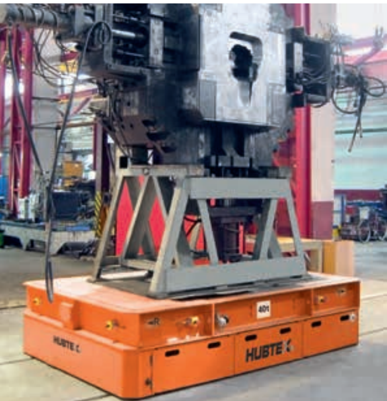
Carro-plataforma, capacidades de 10 – 63 t Transportador de plataforma, capacidad de carga de 10 – 63 t
