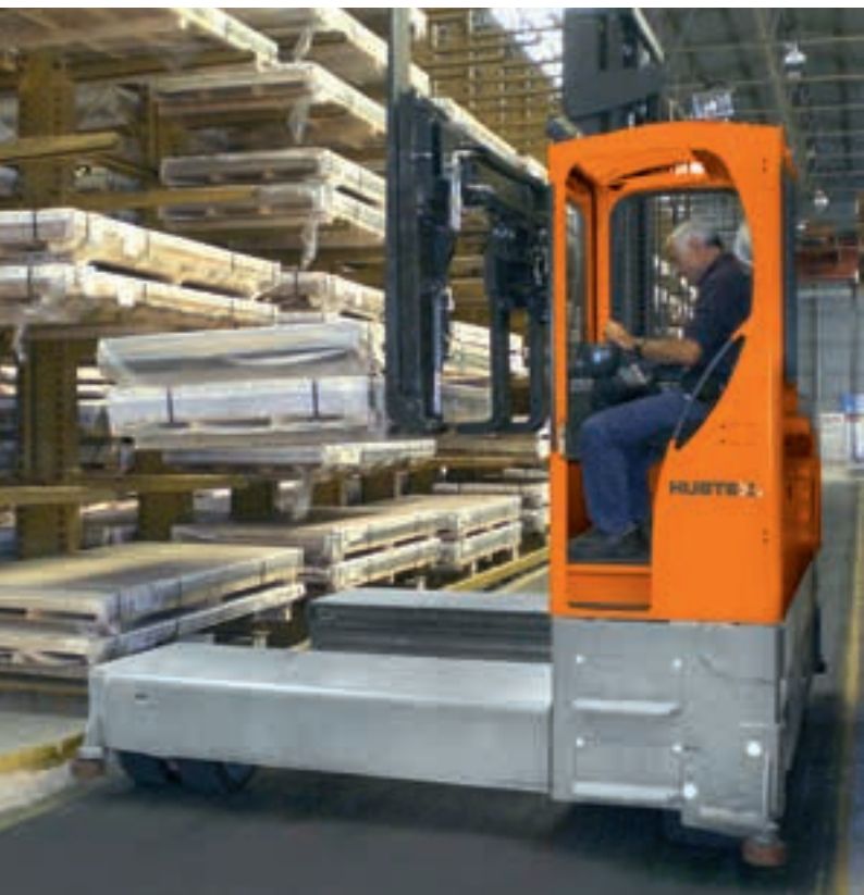
Empilhadeira elétrica lateral, multidirecional, em armazem de chapas Carretilla multidireccional eléctrica manipulando planchas de aluminio
