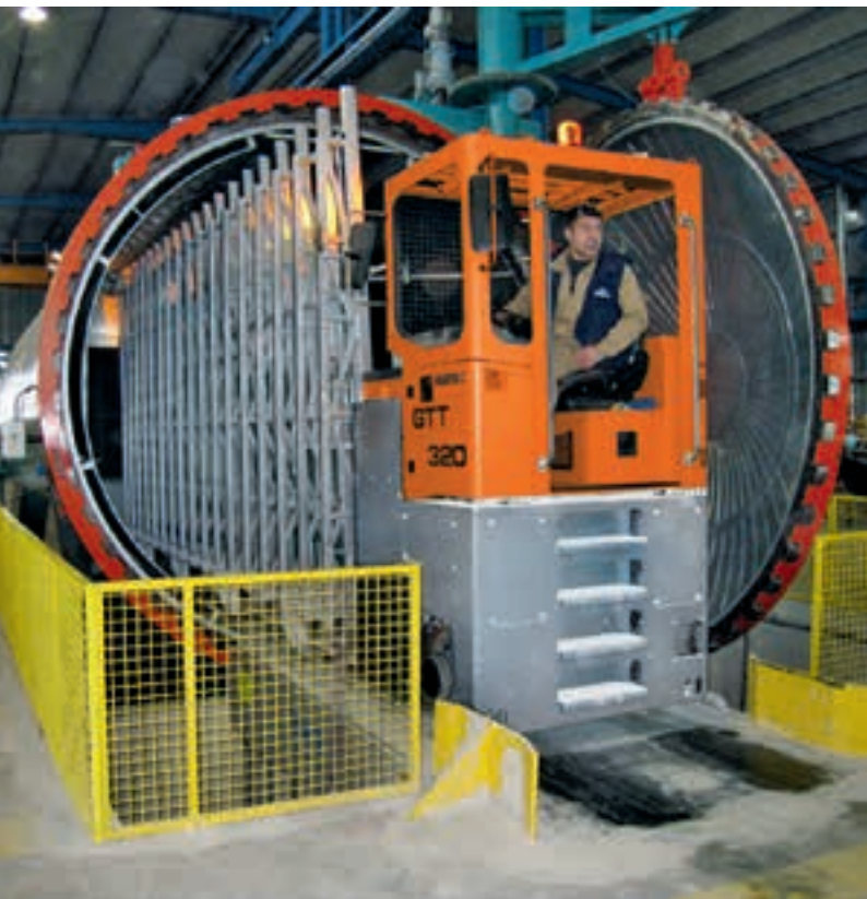
Carga e descarga de cavaletes de vidro em um autoclave Carretilla transportadora de caballetes de vidrio en un sistema de autoclave
