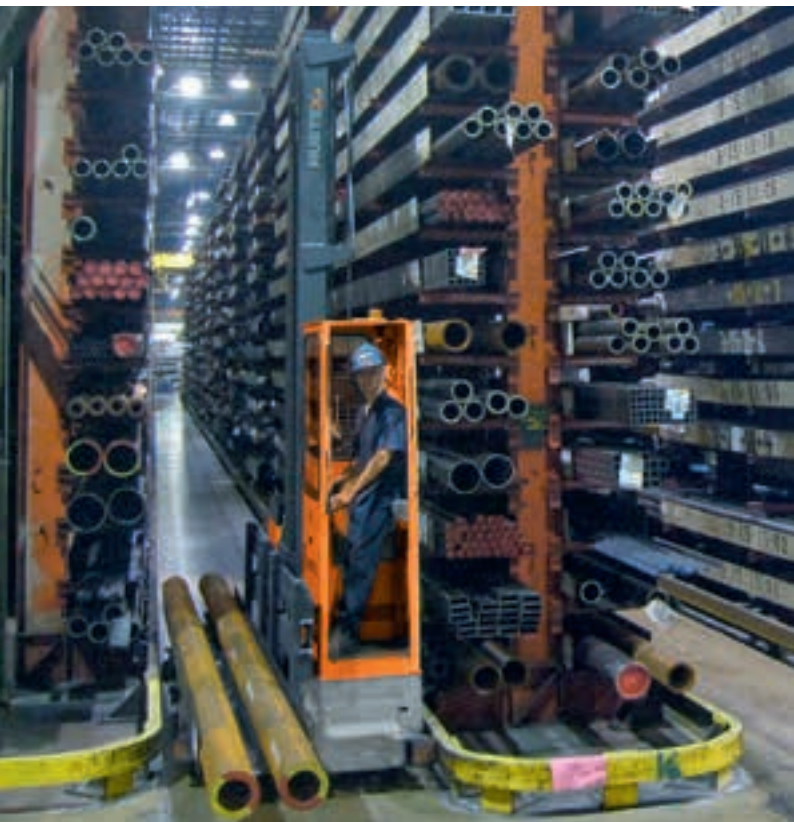
Empilhadeira eléctrica lateral, multidireccional em corredores estreitos Carretilla multidireccional eléctrica en pasillo guiado
