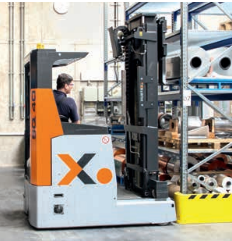
Empilhadeira retrátil com mastro em execução compacta Carretilla con horquilla retráctil de diseño compacto
