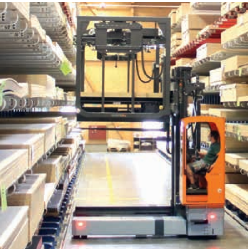
Empilhadeira lateral eléctrica multidireccional com dispositivo removível de ventosas Carretilla elevadora lateral eléctrica multidireccional con dispositivo de vacío extraíble
