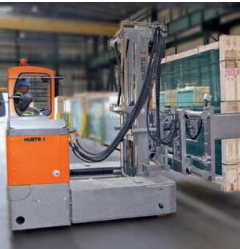
Empilhadeira elétrica lateral, multidirecional, no transporte de vidro embalado Carretilla multidireccional eléctrica para la manipulación de marcos de vidrio
