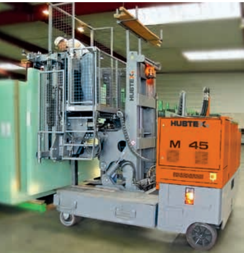
Empilhadeira eléctrica lateral, multidireccional, no transporte de vidro solto (open glass) Carretilla multidireccional eléctrica para manipulación de hojas de vidro
