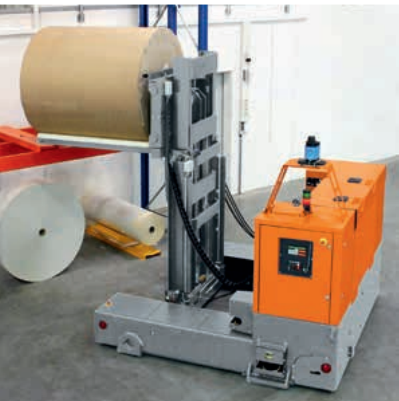
Sistema de transporte sem condutor para a movimentação de rolos Sistema de transporte sin conductor para el manejo de rollos
