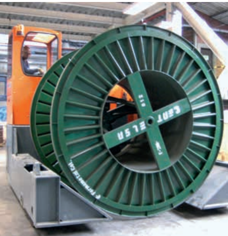
Transportador de carretéis de cabos, com capacidade de até 50 t Transportadora de carretes con capacidad de hasta 50 t
