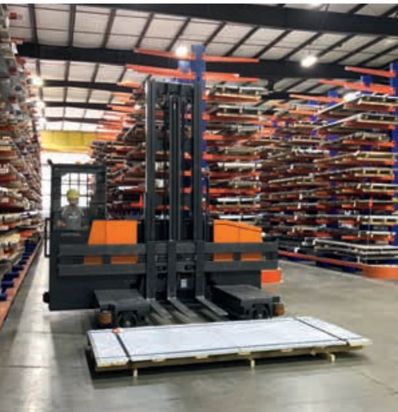
Empilhadeira elétrica multidirecional com acesso de baixa altura para a cabine Carretilla elevadora multidireccional eléctrica con escasa altura de acceso a la cabina
