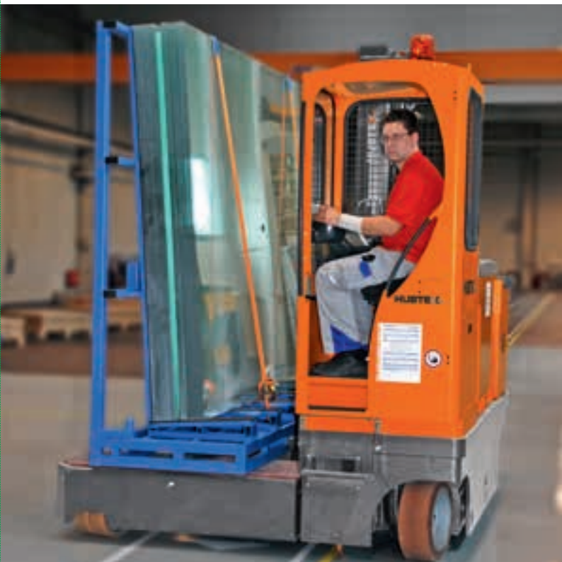
Transporte de vidrio virgem para geradores de energia solar Carretilla multidireccional eléctrica manipulando caballetes de vidrio en la industria solar
