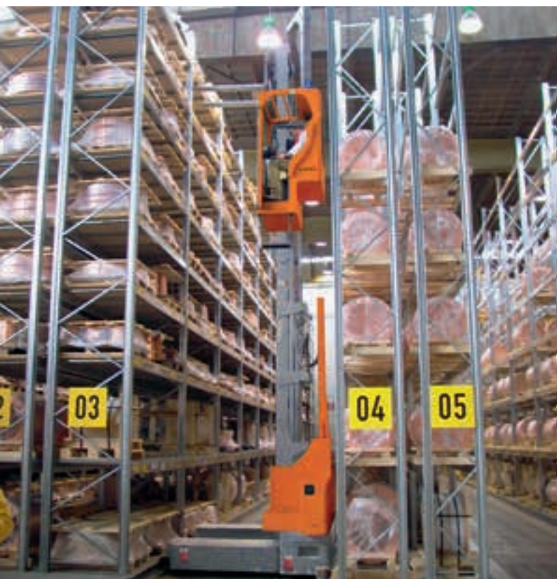
Empilhadeira elétrica lateral, multidirecional, com cabina elevatória Carretilla multidireccional eléctrica con cabina elevable
