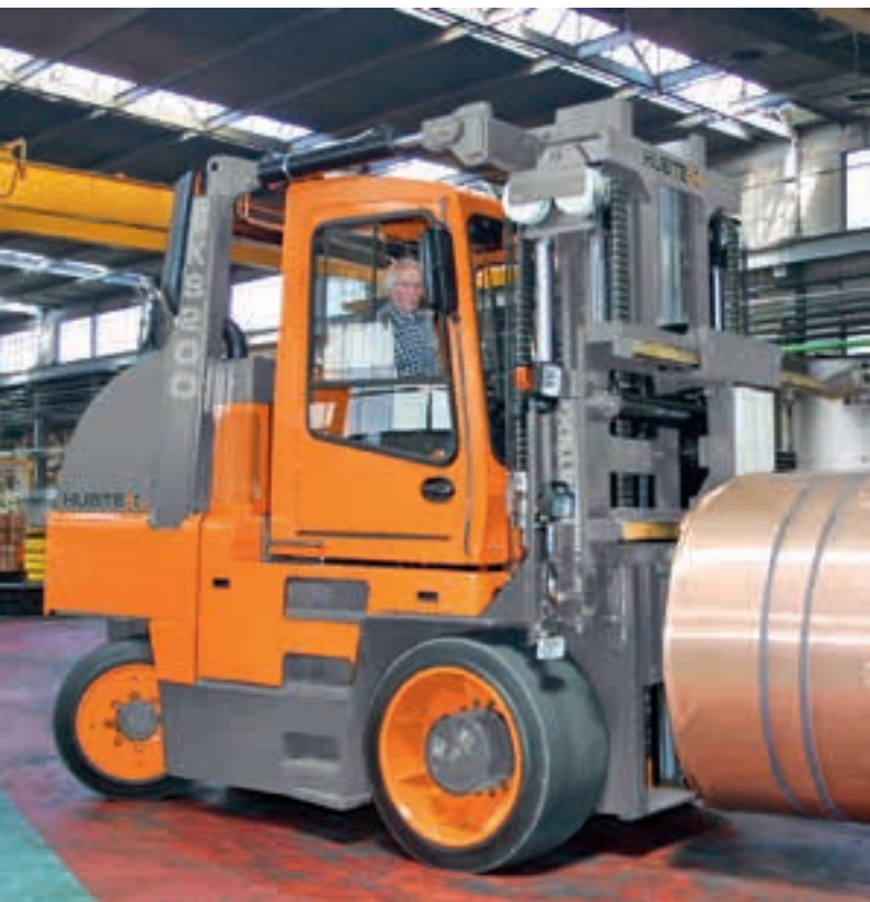
Empilhadeira compacta a GLP, capacidade de 20 t Carretilla frontal compacta a gas LPG de 20 t
