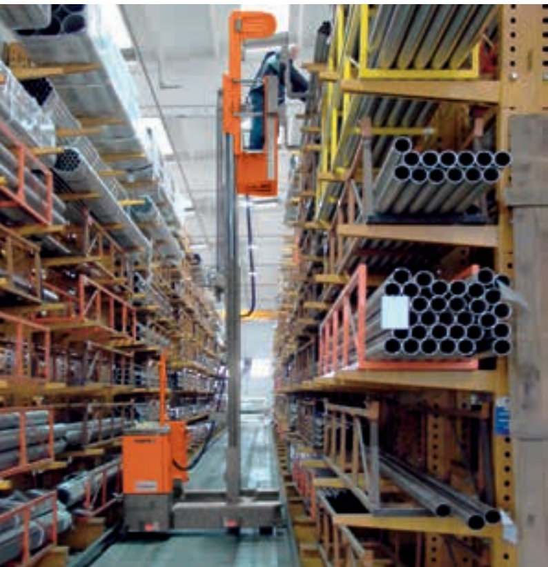
Empilhadeira elétrica lateral, multidirecional, para o selecionamento de tubos e perfis Carretilla multidireccional eléctrica de picking deargas largas
