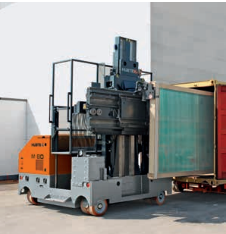
Carga e descarga de vidro embalado, em containeres fechados Carga/Descarga de marcos de vidro en contenedor
