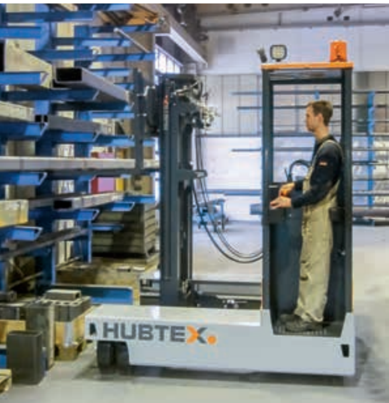
Empilhadeira lateral eléctrica multidireccional de três rodas Carretilla elevadora lateral eléctrica multidireccional de tres ruedas
