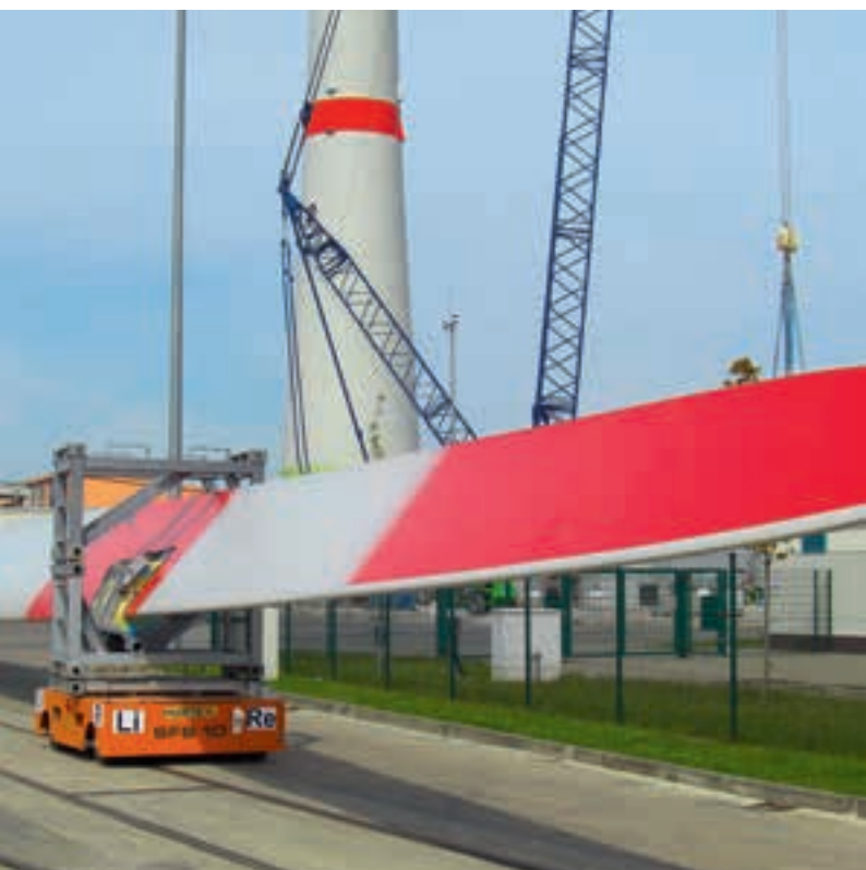
Plataforma elétrica transportadora das hélices de geradores eólicos Plataforma transportadora manipulando asas de molinos eólicos
