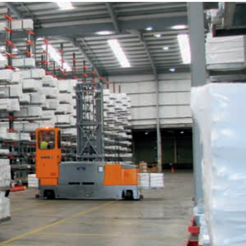
Empilhadeira elétrica lateral, multidirecional na movimentação de unitizadores de carga Carretilla multidireccional eléctrica manipulando jaulas de perfíles PVC
