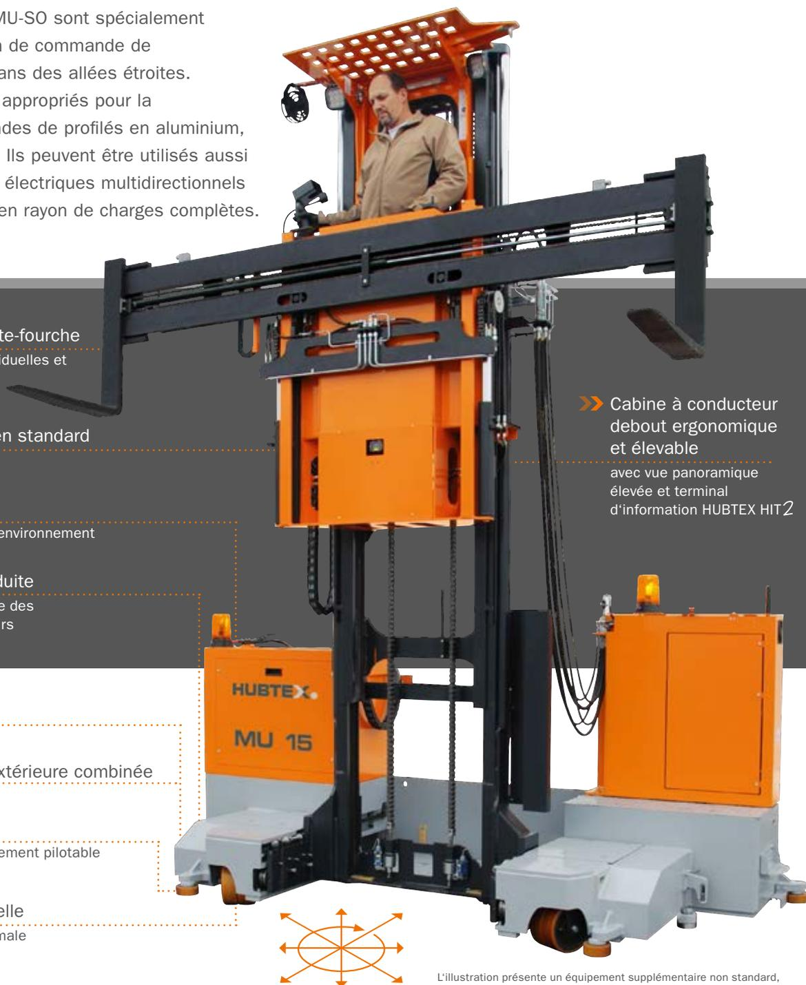
L'illustration présente un équipement supplémentaire non standard, en particulier une largeur réduite de l'appareil par la suppression de la batterie derrière le mât.
