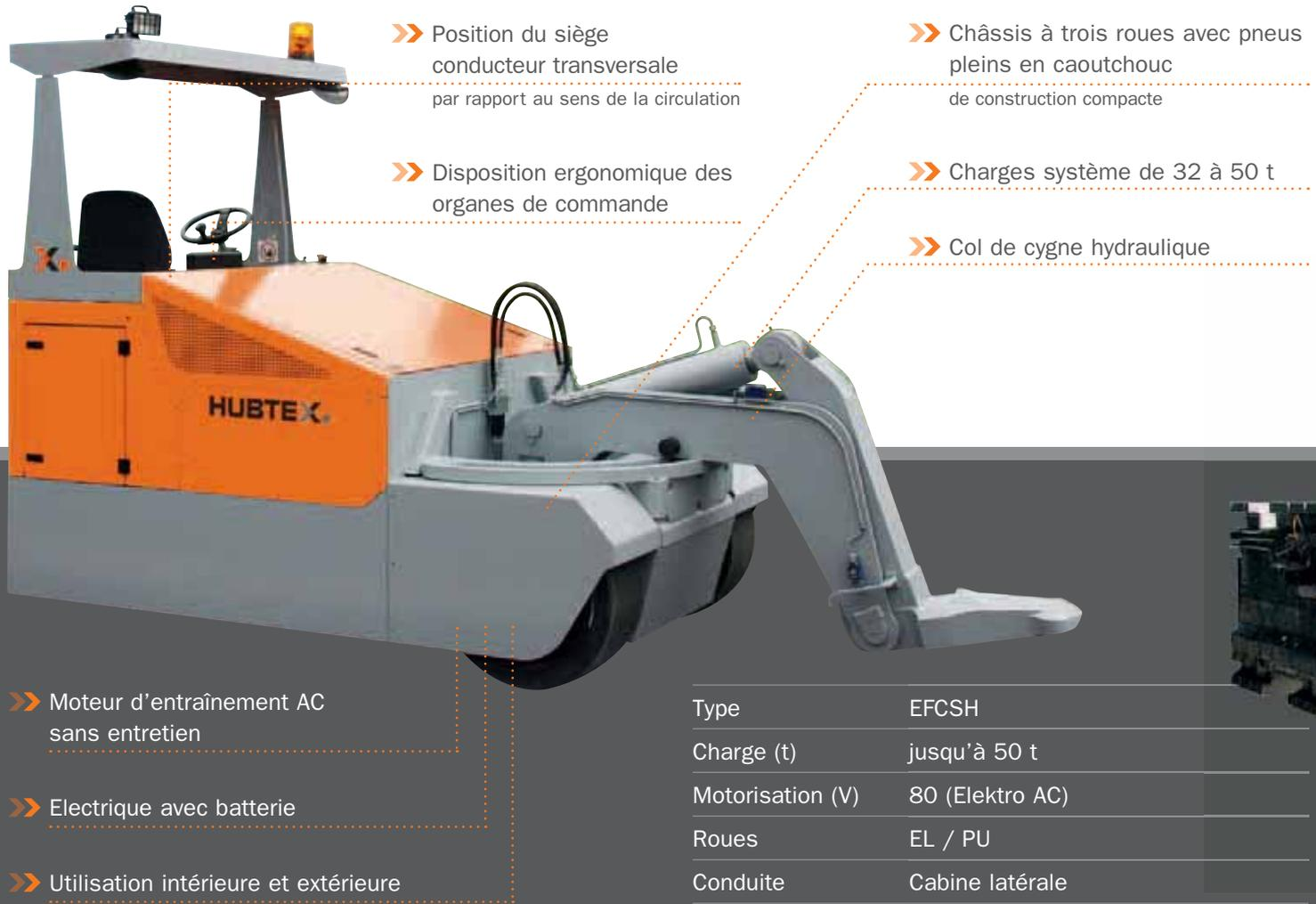
» Position du siège conducteur transversale par rapport au sens de la circulation
