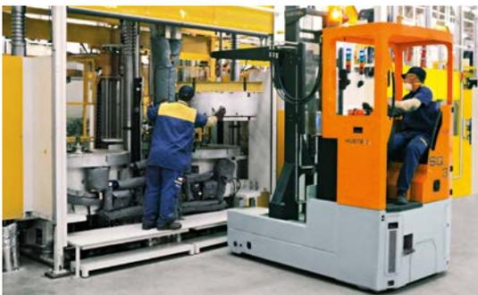
Die HUBTEX-Schubmaststapler SQ zeichnen sich durch die Kombination von kompaktem Design und hohen Tragfähigkeiten bis zu 6 t aus. Dadurch kann der SQ trotz höherer Tragfähigkeiten in den gleichen Arbeitsgangbreiten wie herkömmliche Schubmaststapler eingesetzt werden. Er eignet sich insbesondere zum Coilhandling.
