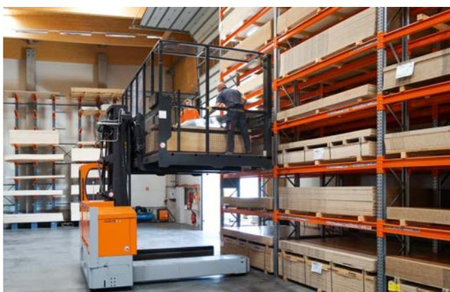
Der klassische Elektro-Mehrwege-Seitenstapler ist bereits in der Basiskonfiguration für das Handling von langen Lasten in engen Gassen ausgelegt.
