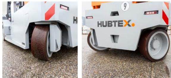
Durch eine neue, patentierte **Einzelradlenkung** verringert sich der Wendekreis erheblich, was im Vergleich zur Standardlenkung in einer zusätzlichen Platzersparnis im Wenderadius von 50% resultiert. Der Drehpunkt des Fahrzeuges liegt in diesem Fall ideal in der Mitte der Antriebsachse.
