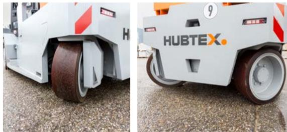
Por medio de una nueva dirección de rueda única patentada se reduce considerablemente el radio de giro, lo que supone un ahorro de espacio adicional en el radio de giro del 50 % en comparación con la dirección estándar. En este caso, el punto de giro del vehículo se encuentra en el centro del eje motriz.
