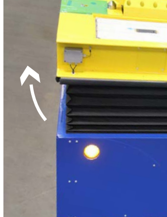
Uçak dümen tertibatını boyahaneye taşımak için asansörlü platform arabası
