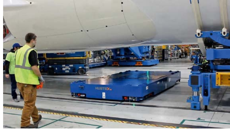
Platform aracı SL-AGV bir uçak gövdesi taşıyor
