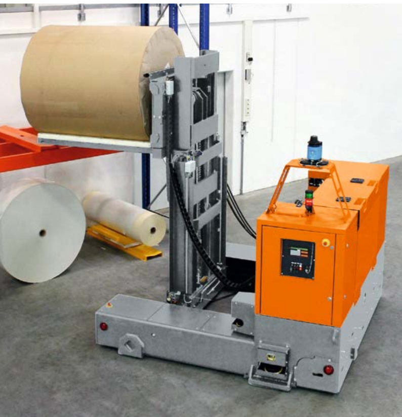
Sürücüsüz bobin taşıma sistemi Automatic guided vehicle for roll handling
