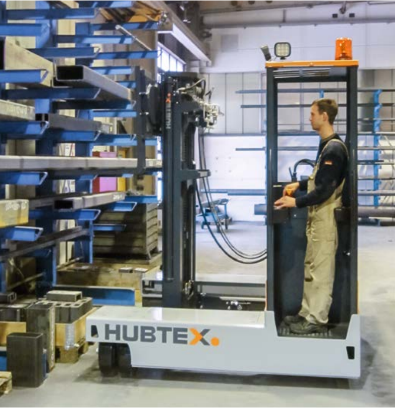
Elektrikl çok yönlü istifleyici, üç tekerlekli modeli Electric-Multidirectional-Sideloader as three-wheel-model
