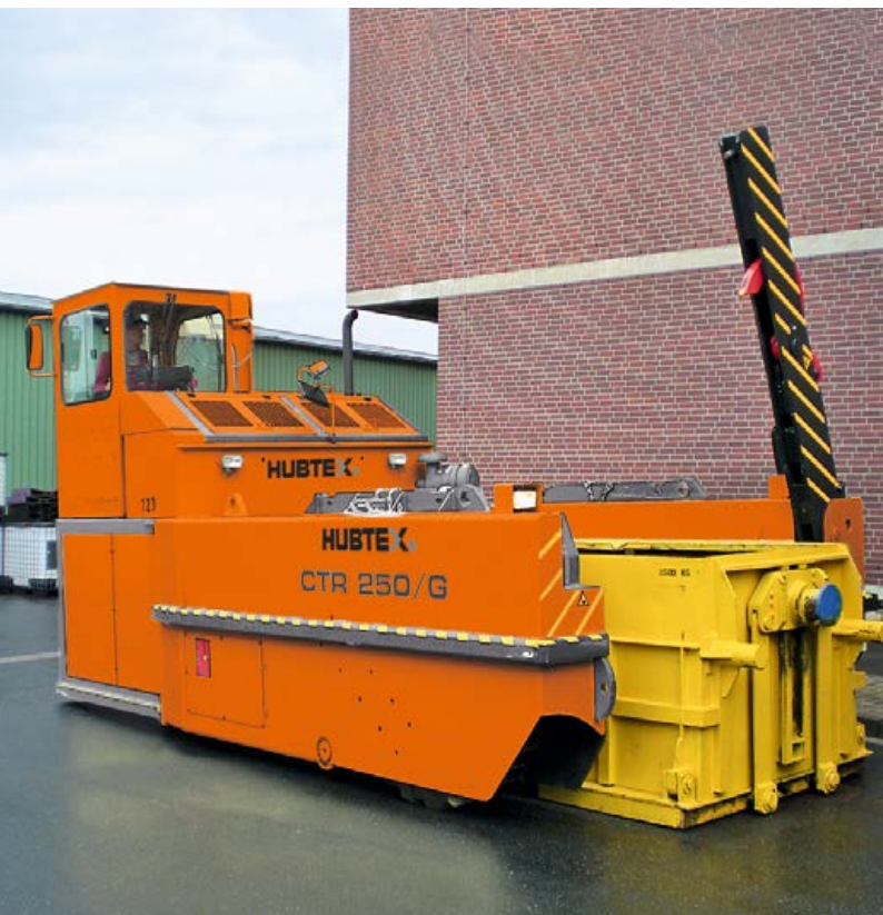
Hurda konteyneri taşıma aracı, taşıma kapasitesi 50 t kadar Transporter for handling of scrap containers, capacity up to 50 t
