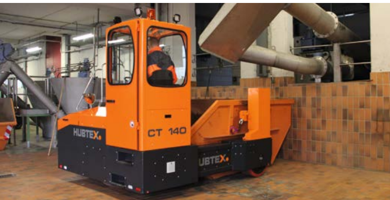
Kaldırma kollu veya çatallı konteyner taşıyıcı Container transporter with forks or lifting gear
