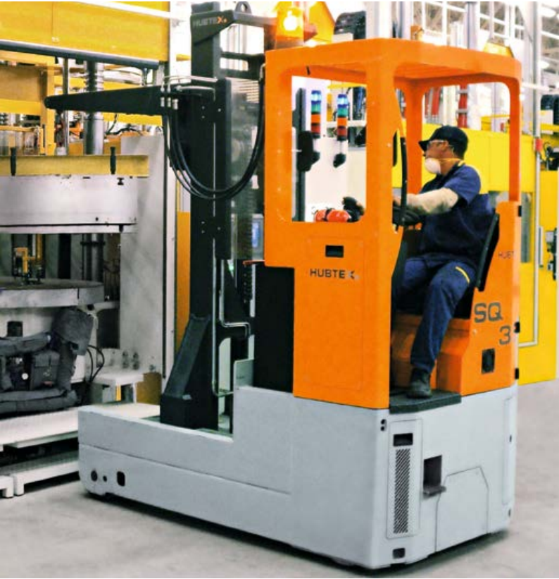
Teker kalıplarını taşıyan Reach Truck Reach truck for handling of tyre moulds
