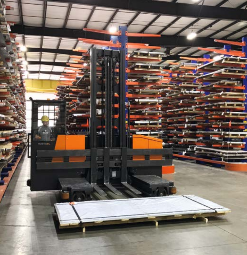
Alçak kabin girişli, elektrikli çok yönlü yanal istifleyici Electric-Multidirectional-Sideloader with low cabin entrance
