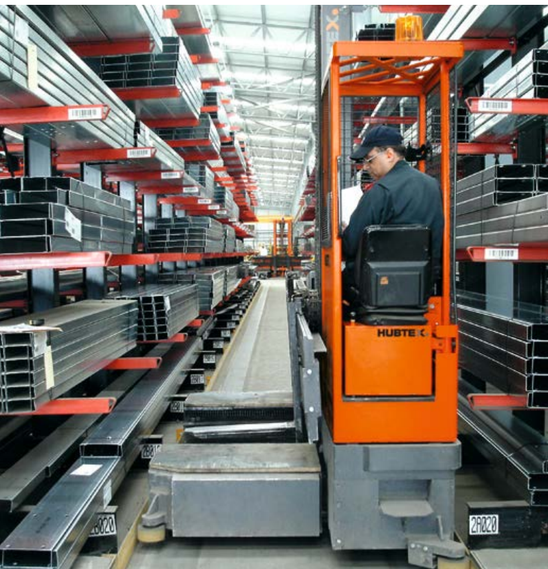
Uzunlamasına oturma kabinli, çok yönlü yanal istifleyici Multidirectional-Sideloader with longitudinal seat cabin
