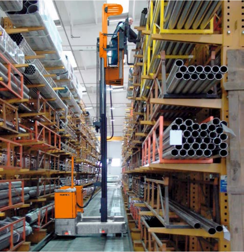
Boru ve Profil siparişlerini toplarken çok yönlü yanal istifleyici Multidirectional-Sideloader for order-picking of tubes and pipes
