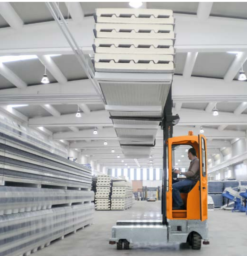
Yumuşak tekerlekli elektrikli çok yönlü yanar istifleyici Electric-Multidirectional-Sideloader with soft tyres
