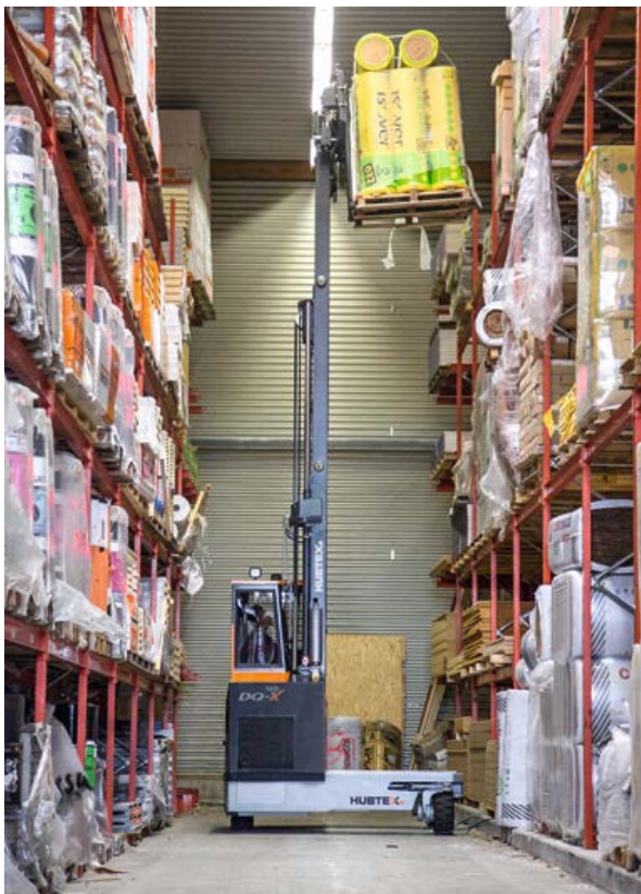
Enerji tasarruflu, dizel motorlu, dört yönlü istif aracı Fourway sideloader with energy-efficient diesel engine
