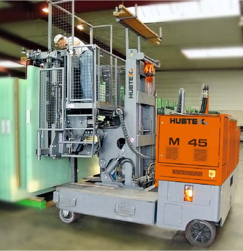
Paketlenmemiş cam paketleri taşımak için çok yönlü yanal istifleyici Multidirectional-Sideloader for handling of unpacked glass packs
