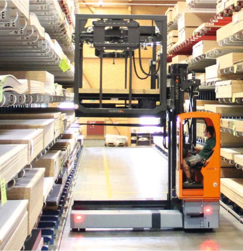
Vakum emiř dzenekli-çok yönlü yanal sipariř toplama aracı Multidirectional-Sideloader with removable vacuum suction device
