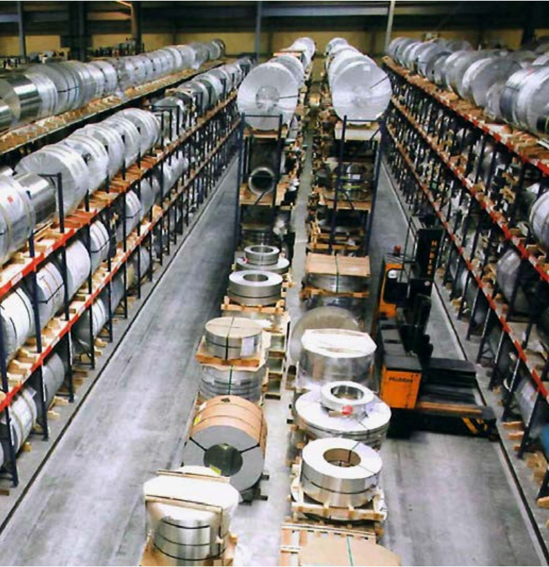
Kalaylı sac deposunda – çok yönlü yanal istifleyici Multidirectional Sideloader in tinplate warehouse
