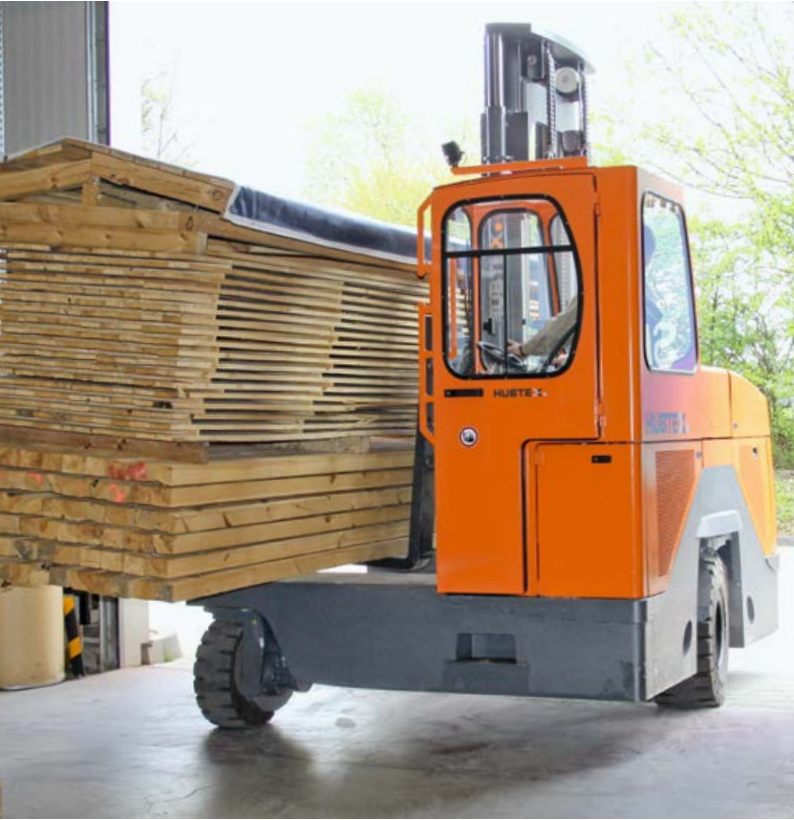
Dört yönlü yanal istileyici, taşıma kapasitesi 6 – 8 t Fourway-Sideloader, capacity 6 – 8 t
