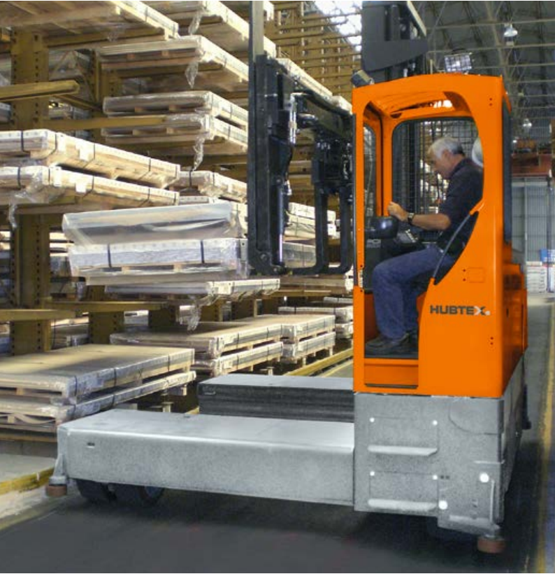
Alüminyum sac deposunda, çok yönlü yanal istifleyici Multidirectional Sideloader aluminium sheet warehouse
