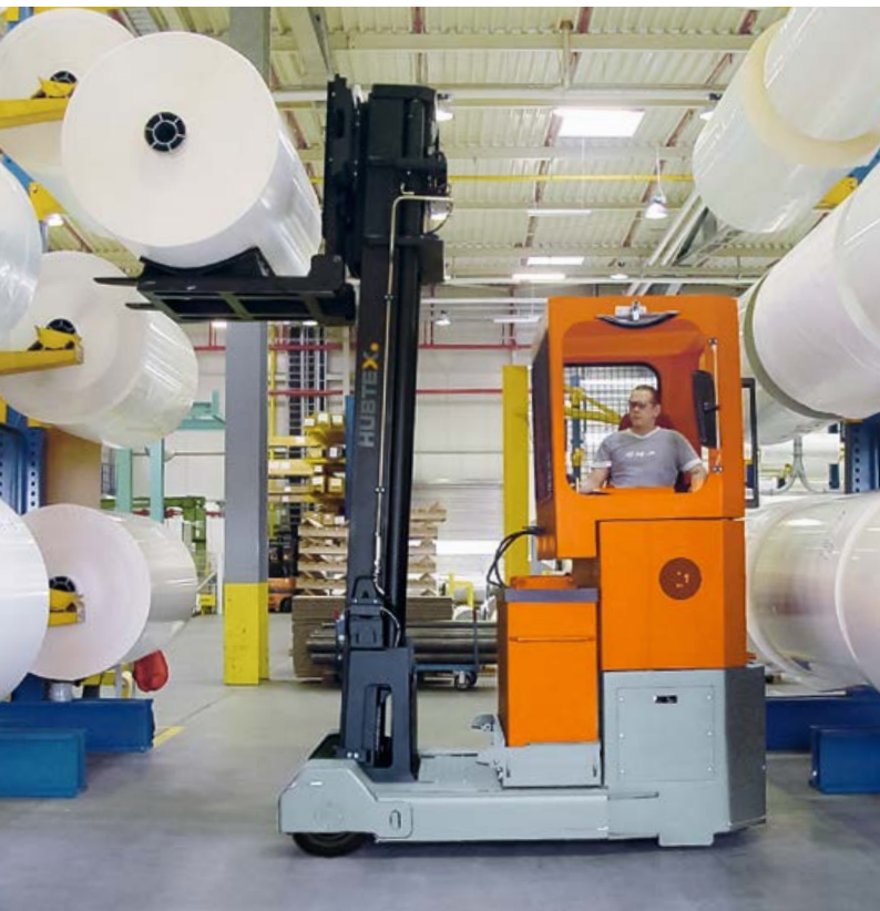
Kağıt ruloların taşınması için Reach Truck, taşıma kapasitesi 3,5 - 6 t Reach truck for handling of paper rolls, capacities 3.5 - 6 t
