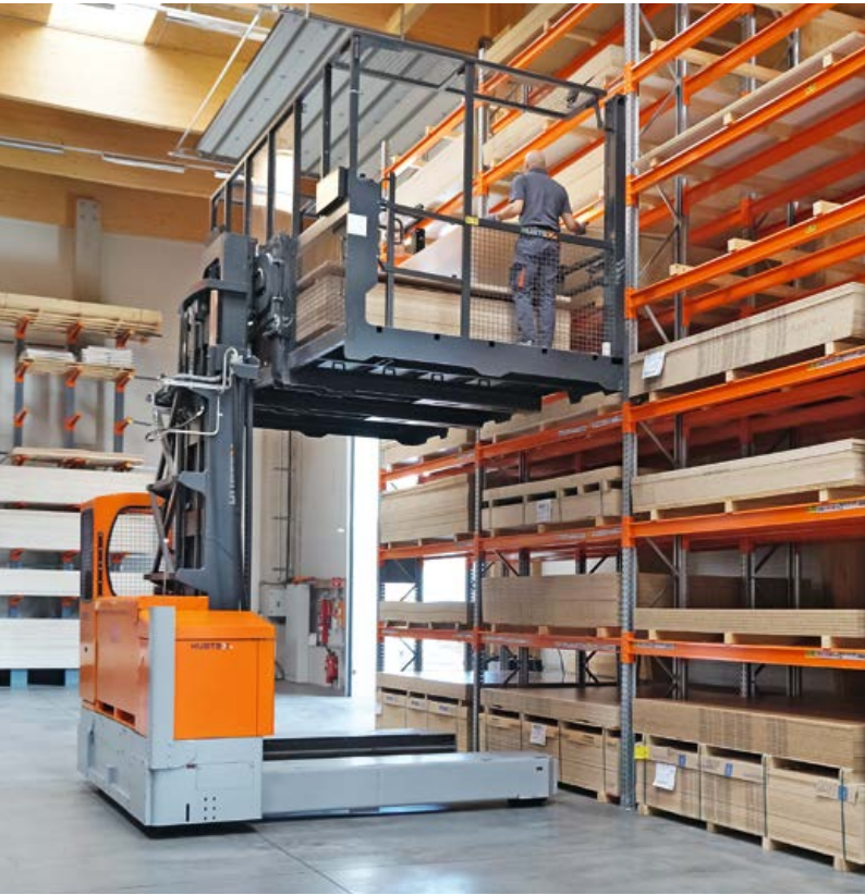
Elektrikli çok yönlü istifleyici, MDF ve Sunta plaka siparişlerini toplarken Picking of boards with an Electric-Multidirectional-Sideloader
