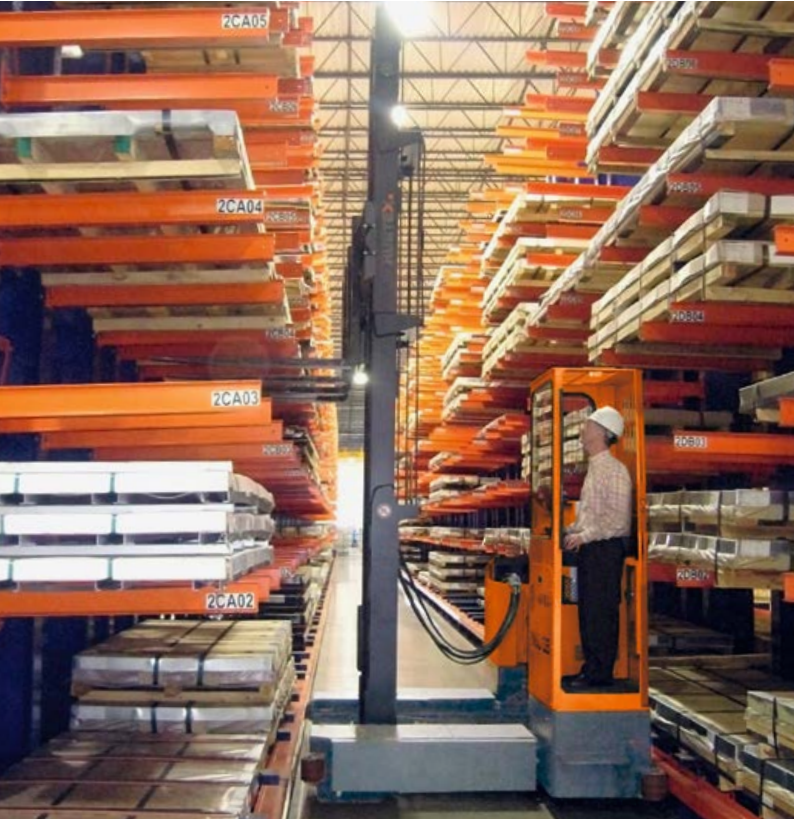
Sac deposunda, çok yönlü yanal istifleyici Multidirectional-Sideloader in sheet metal stockyard
