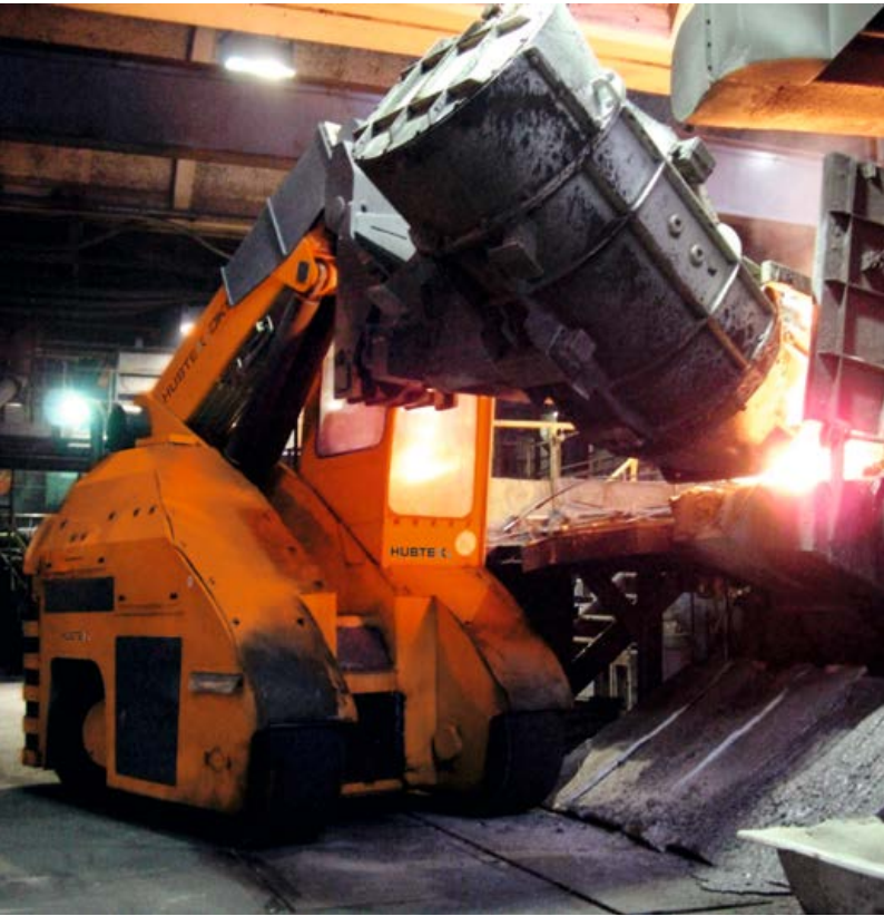
Konverterlerin aktarımı için teleskop kollu-kompakt istif aracı Compact frontlift with telescopic lift-arm for handling of converters
