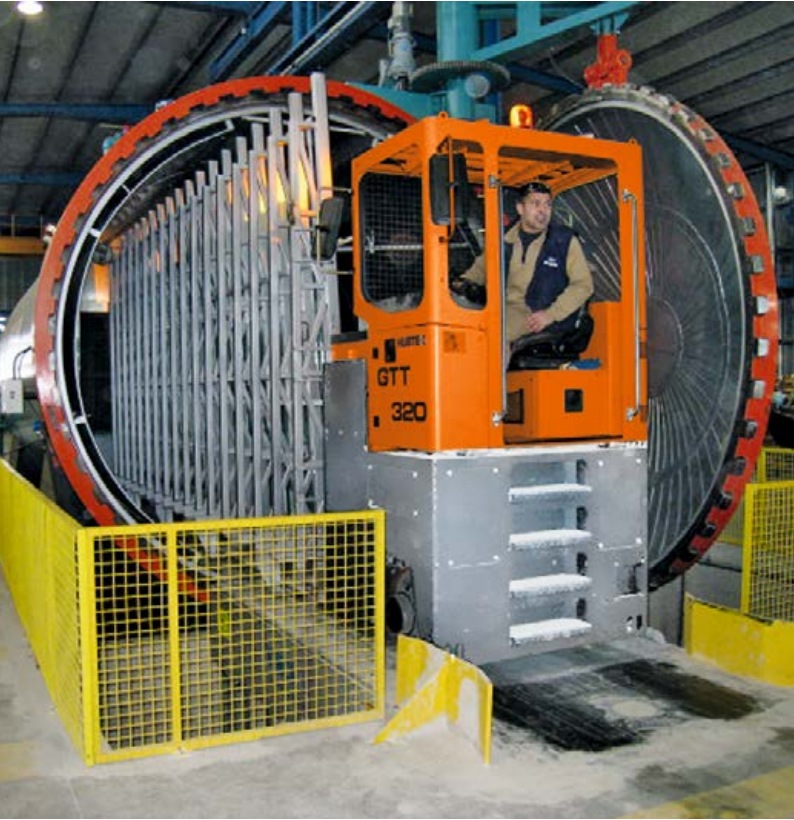
Otoklav sisteminde cam rafların yerleştirilmesi veya alınması Loading and unloading of glass stillages at an autoclave system
