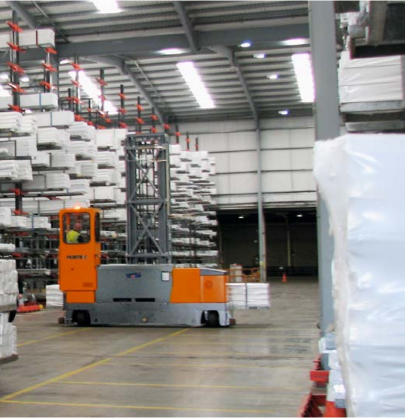
Profil kasetlerin aktarılması için, çok yönlü yanal istifleyici Multidirectional-Sideloader for handling of profile boxes
