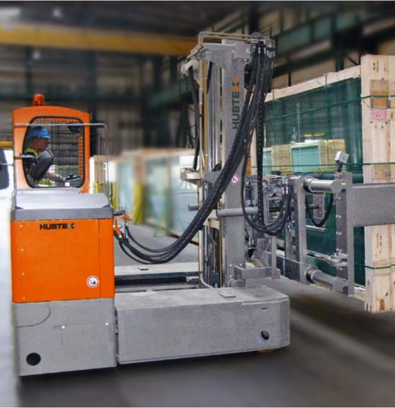
Paketlenmiş cam paketlerin aktarımı için çok yönlü yanal istifleyici Multidirectional-Sideloader for handling of packed glass packs
