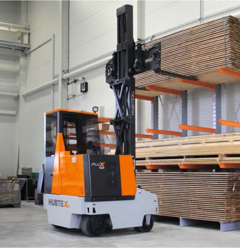
Kereste taşımacılığında çok yönlü yanal istifleyici Multidirectional-Sidelaoder for handling of trimmed timber
