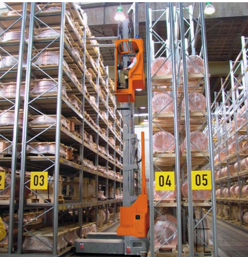
Yükselen kabinli-çok yönlü yanal istifleyici Multidirectional Sideloader with man-up cabin
