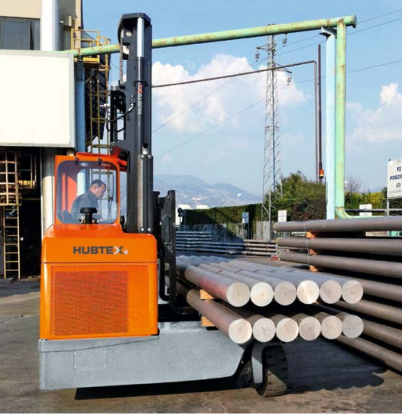
Yumuşak tekerlekli Dizel-dört yönlü-yanal istifleyici Diesel-Forway-Sideloader with soft tyres
