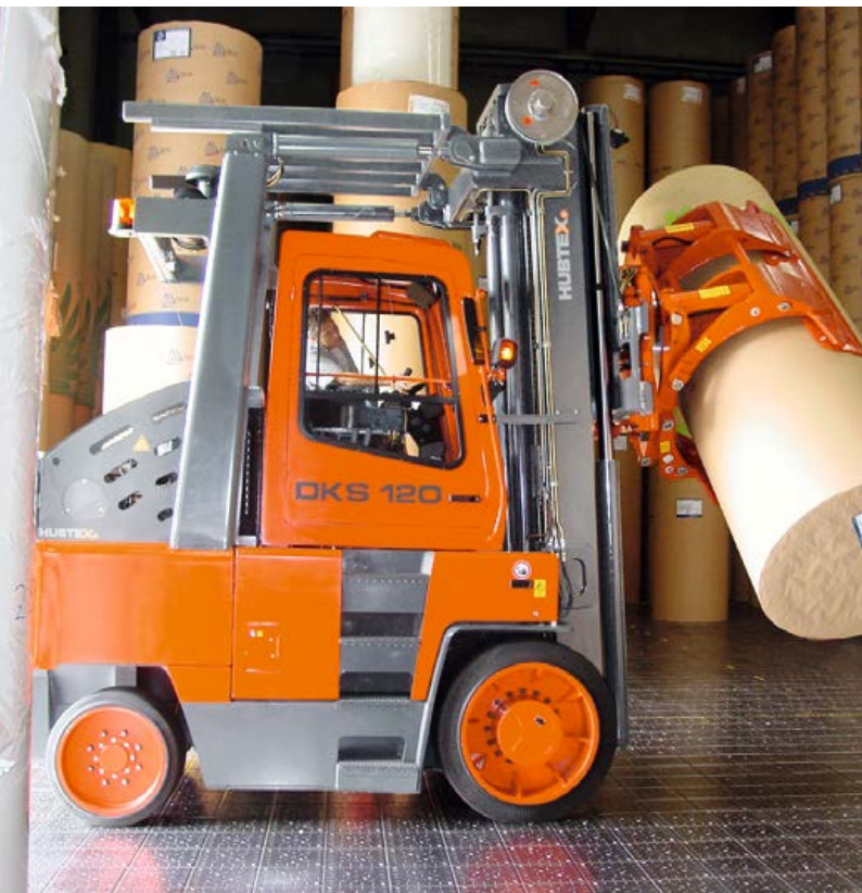
Dönerli ve kağıt rulo kelepçeli kompakt önden çatallı Compact frontlift with rotatable paper roll clamp
