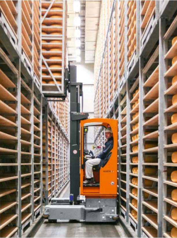
Tekerlek peynir siparişlerin toplanması için çok yönlü yanıl istifleyici Multidirectional-Sideloader in a cheese warehouse
