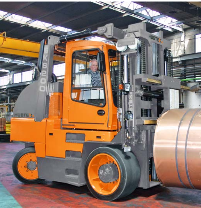
LPG'li kompakt istifleyici, taşıma kapasitesi 20 t LPG-powered compact frontlift, capacity 20 t
