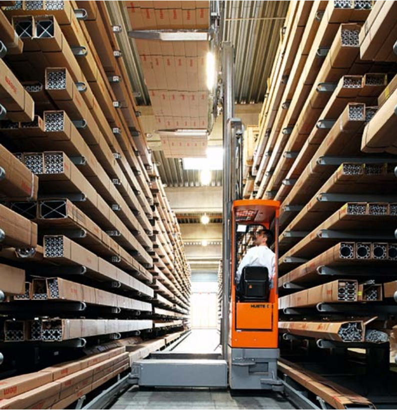
Dar koridorda elektrikli-çok yönlü yanal istifleyici Electric-Multidirectional-Sideloader in narrow aisle application
