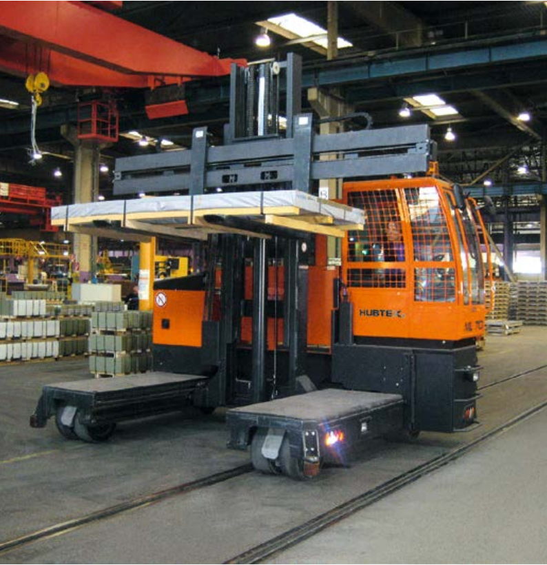
Sideloader kabinli, elektrikli çok yönlü yanal istifleyici
