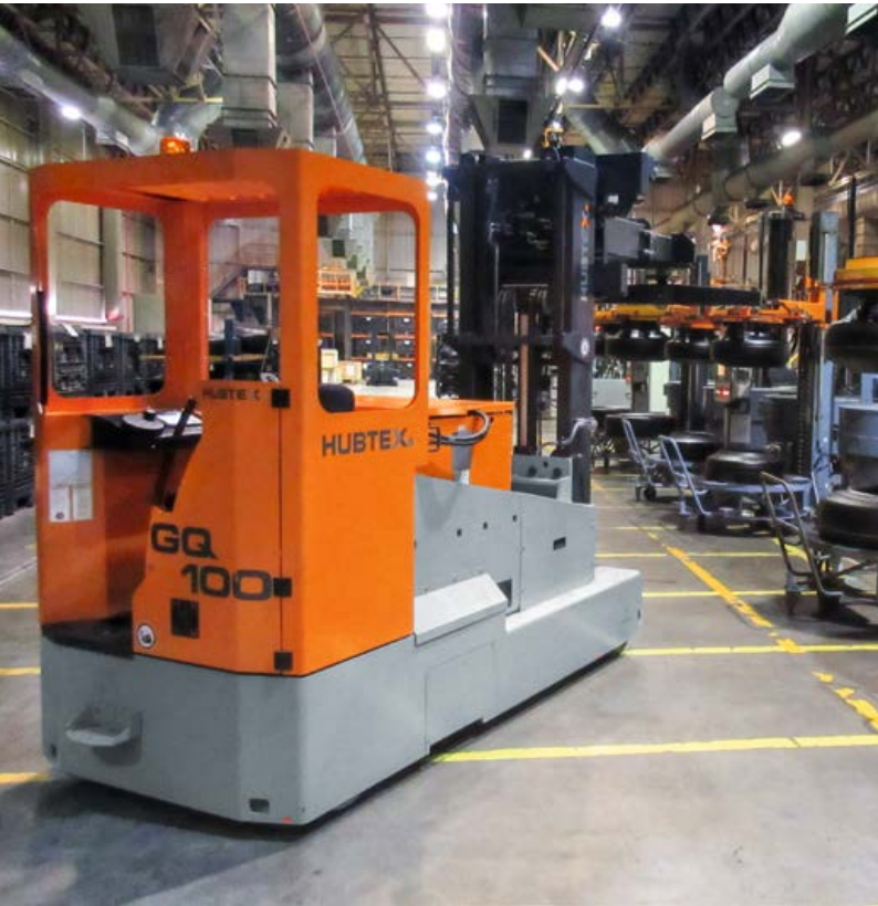
Tekerlek üretiminde, kalıp değiştiren Reach Truck Reach truck changing dies at the tires industry
