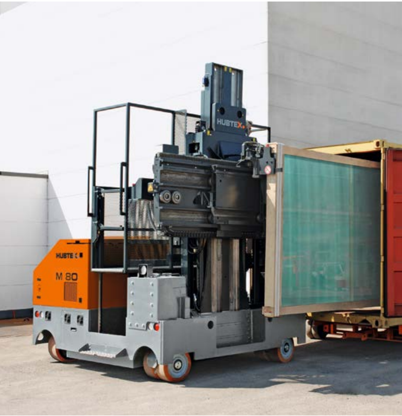
Konteynerden paketlenmiş cam paketlerin yüklenmesi ve boşaltılması Loading/Unloading of packed glass packs into/out of sea containers
