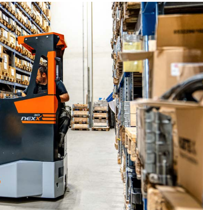
Kompakter Mehrwege-Schubmaststapler für Mischlager mit engen Gängen Compact multidirectional reach truck for mixed warehouses with narrow aisles
