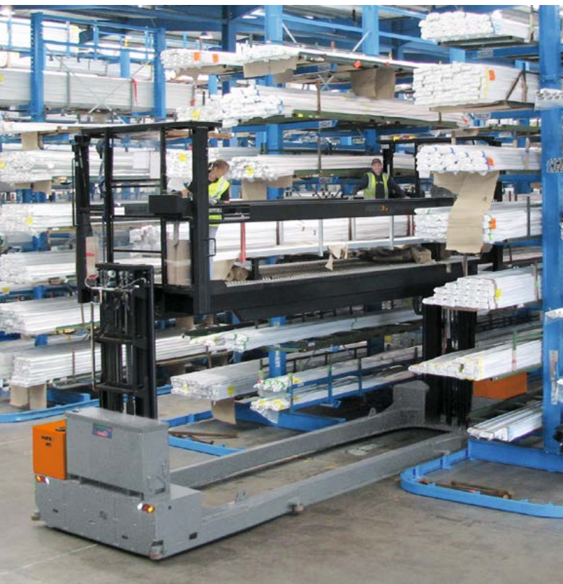
Zweiseiten-Kommissionierer für den Schmalgangeinsatz Two-side order picker for narrow aisle applications
