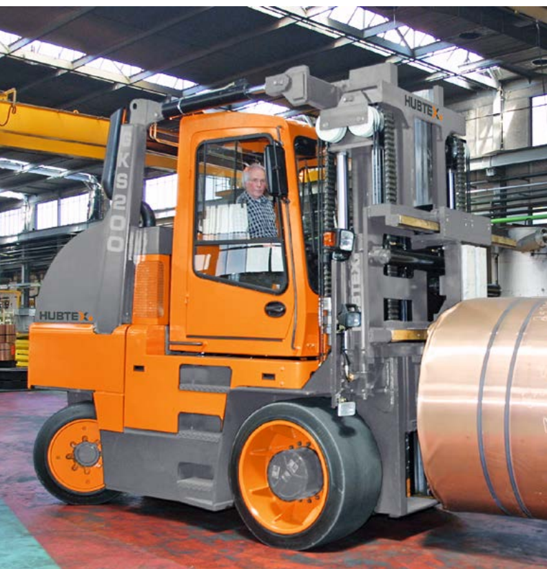
Kompaktstapler, Tragfähigkeit 20 t Compact frontlift, capacity 20 t
