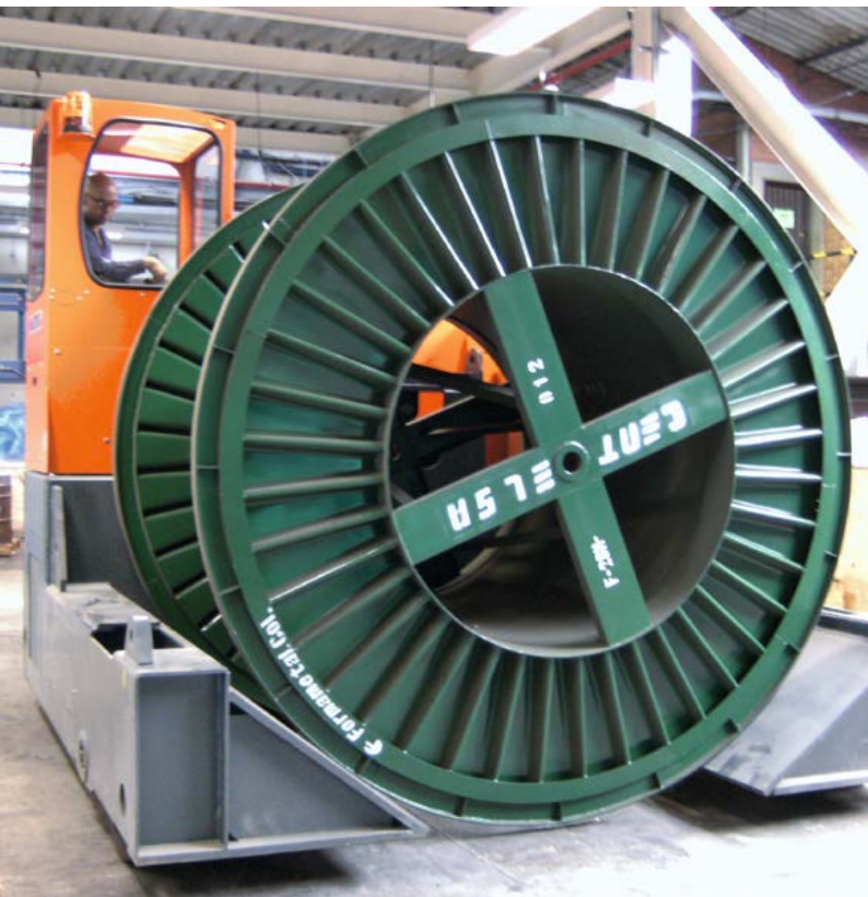
Trommeltransporter, Tragfähigkeiten bis 20 t Drum transporters with capacities up to 20 t
