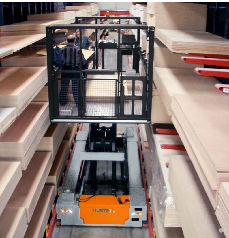
Zweiseiten-Kommissionier-Plattform, Tragfähigkeiten 2 – 12 t Two-side order picking platform, capacity 2 – 12 t
