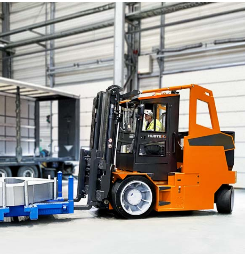
Elektro-Schwerlast-Kompaktstapler mit bis zu 30 t Tragfähigkeit Electric heavy-duty compact forklift truck with up to 30 t load capacity
