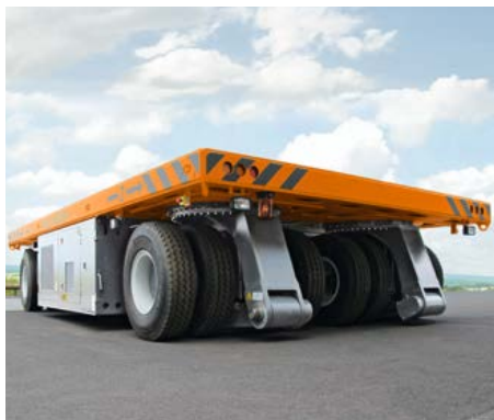
Luftbereifter Mehrwege- Plattformtransporter, Tragfähigkeit bis 80 t Multidirectional platform- transporter with pneumatic tyres, capacity up to 80 t
