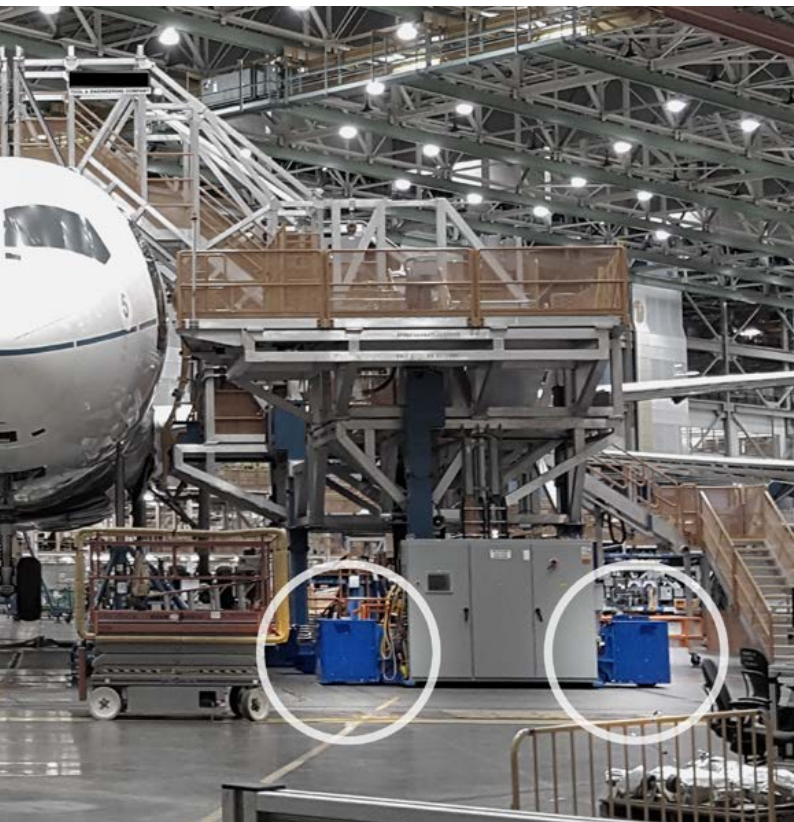
Antriebs- und Lastradeinheiten mobilisieren stationäre Arbeitsplattformen Drive and load wheel units mobilize stationary work platforms
