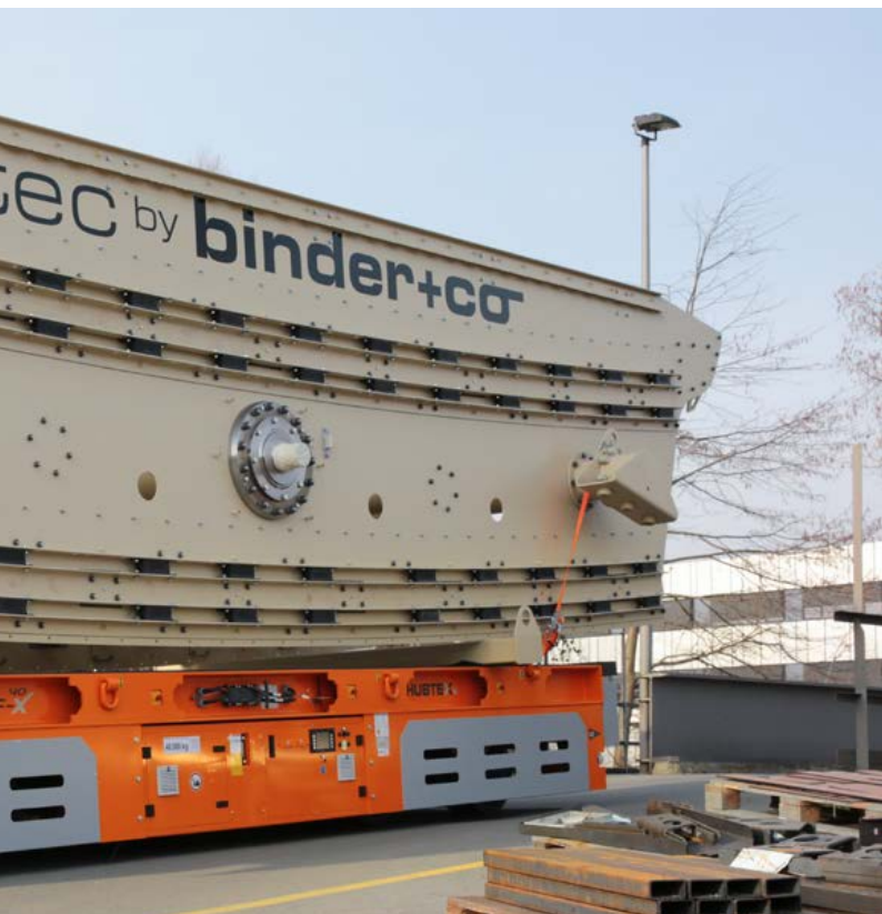
Plattformwagen, Tragfähigkeiten bis 130 t Platform truck, capacities up to 130 t
