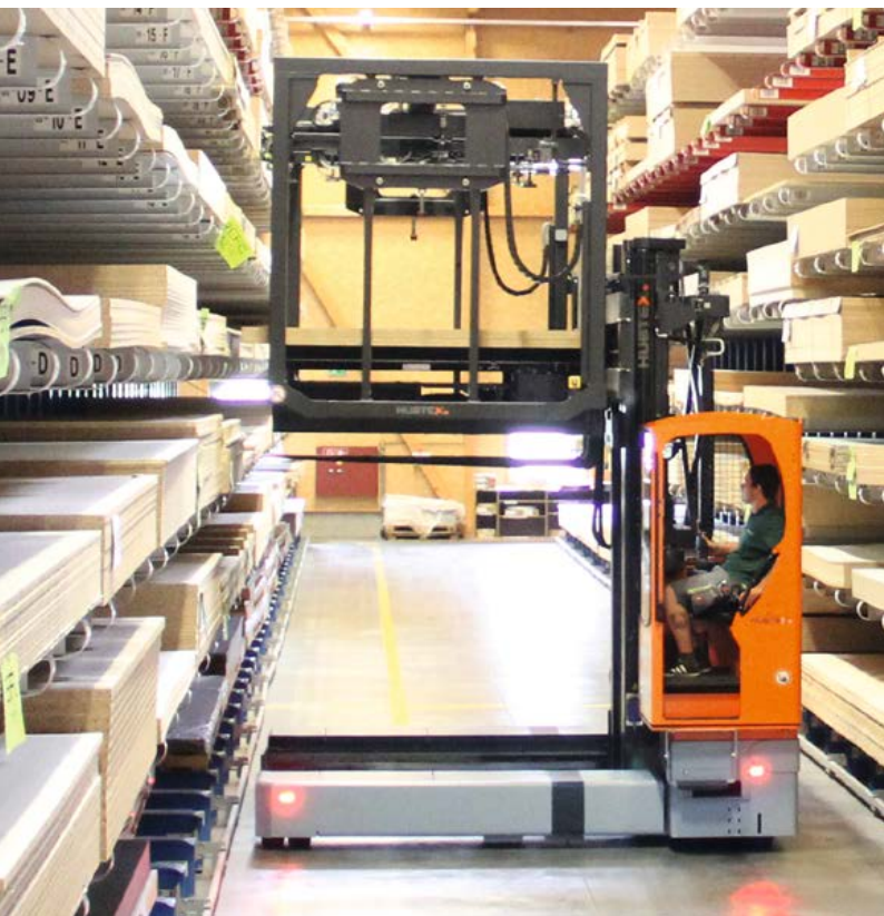
Mehrwege-Seitenstapler mit aufnehmbarer Vakuum-Kommissioniervorrichtung Multidirectional-Sideloader with removable vacuum suction device
