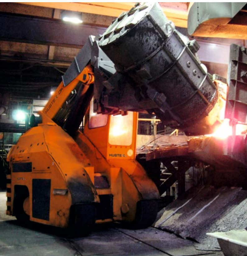
Teleskoparm-Kompaktstapler für das Handling von Konvertern Compact frontlift with telescopic lift-arm for handling of converters
