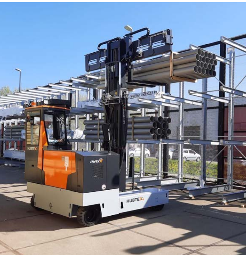
Mehrwege-Seitenstapler mit Elastikrädern für den Innen-/Außeneinsatz Multidirectional-Sideloader with rubber tyres for in- and outdoor use
