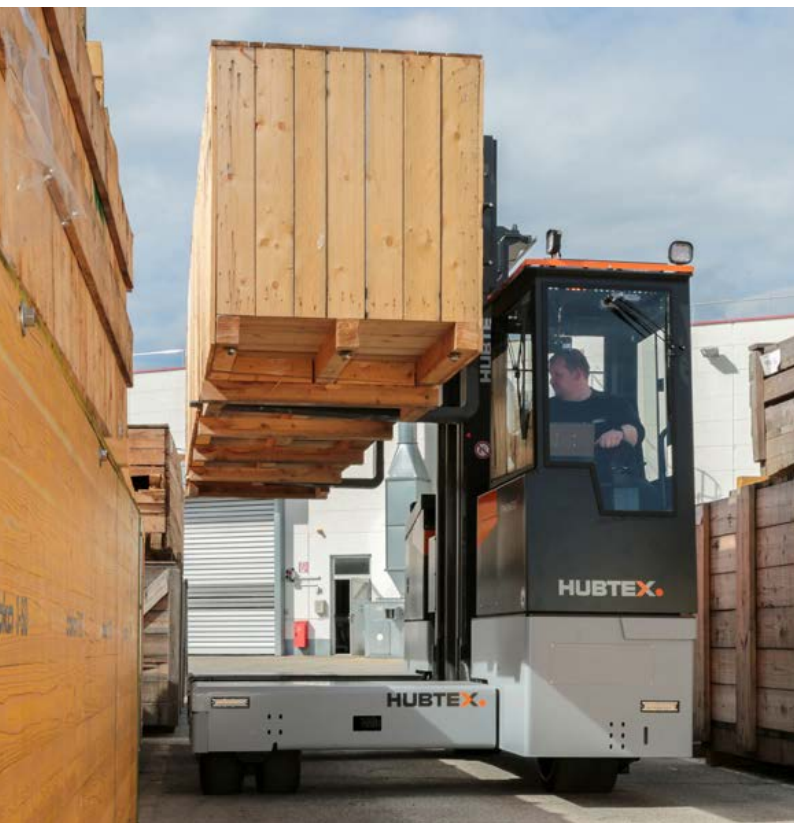
Elektro-Mehrwege-Seitenstapler mit Seitenstaplerkabine Electric Multidirectional Sideloader with sideloader cabin
