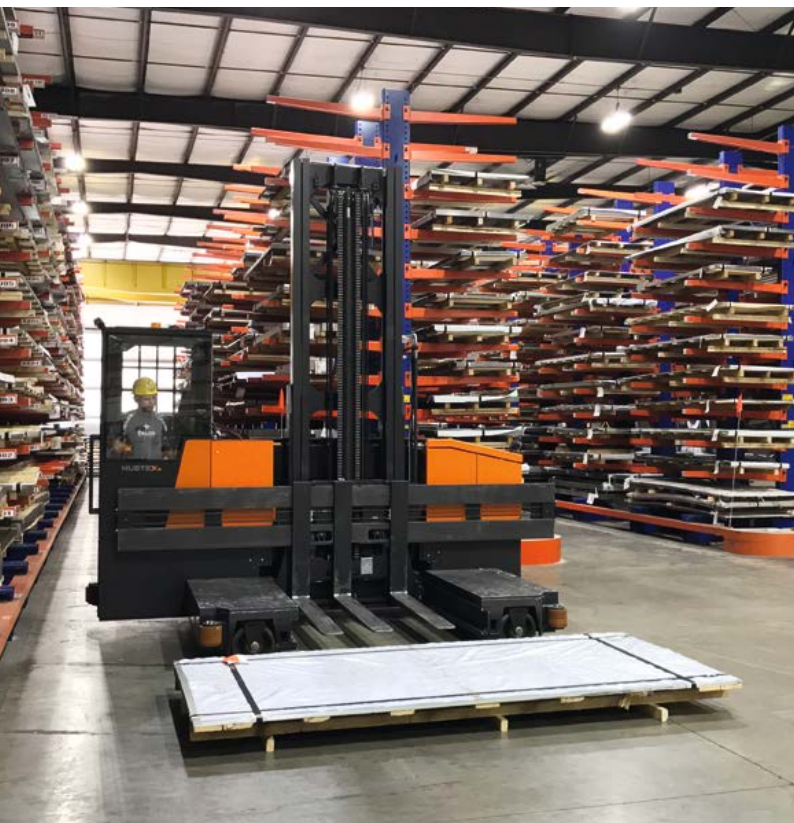
Elektro-Mehrwegestapler mit niedrigem Kabineneinstieg Electric-Multidirectional-Sideloader with low cabin entrance
