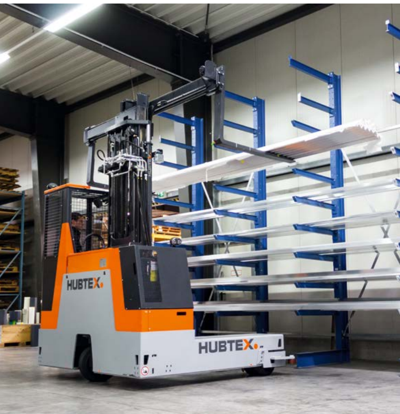
Mehrwege-Seitenstapler mit niedriger Einstiegshöhe Multidirectional Sideloader with low access height
