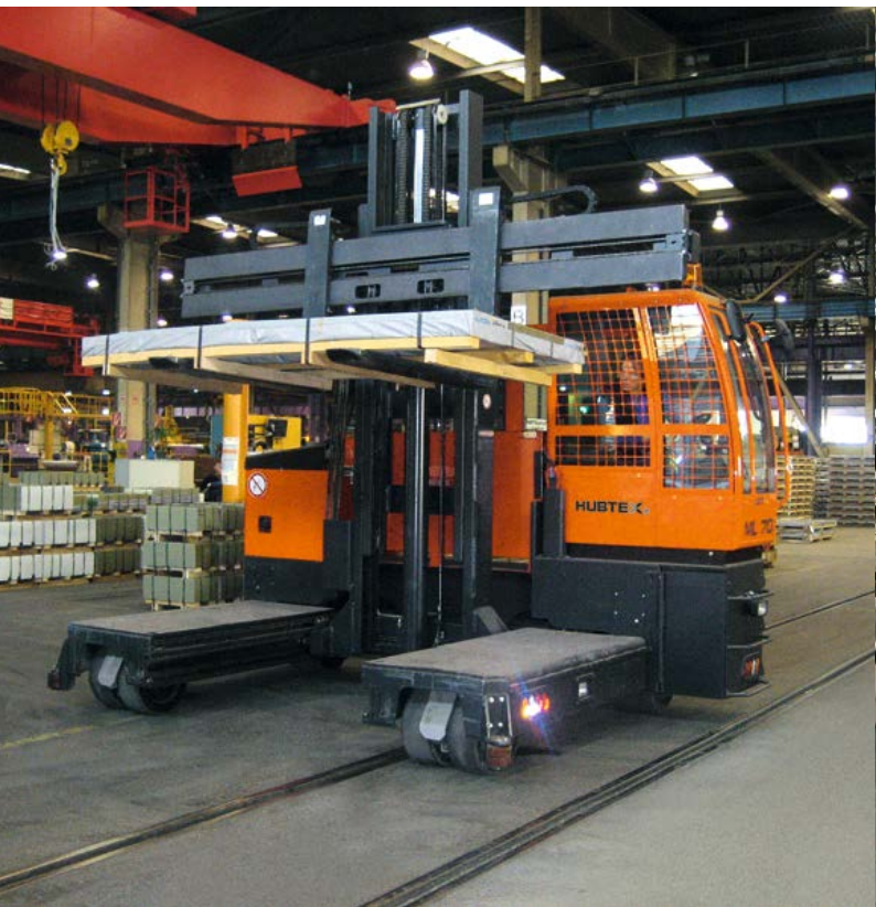
Elektro-Mehrwege-Seitenstapler mit Seitenstaplerkabine Electric-Multidirectional-Sideloader with sideloader cabin
