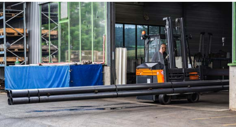
Mehrwege-Gegengewichtsstapler für das Handling von Paletten und Langgut Multidirectional counterbalance truck for handling pallets and long loads
